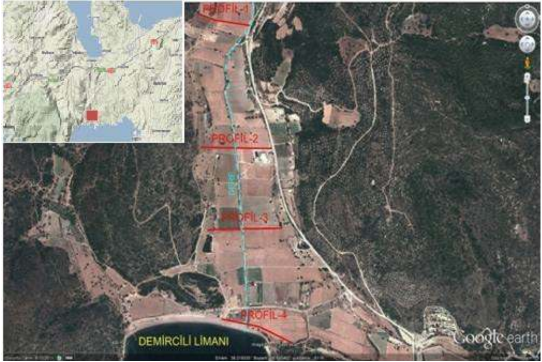
Şekil 5.4 Urla-Demircili çalışma alanında EM-VLF ve doğal potansiyel ölçüm profillerini (kırmızı çizgiler) gösteren uydu görüntüsü.
