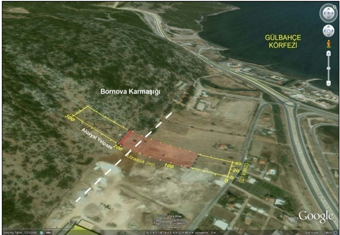
Şekil 5.3 Urla-İçmeler çalışma alanında EM-VLF ve doğal potansiyel ölçüm profillerini (kırmızı çizgiler) gösteren uydu görüntüsü.
