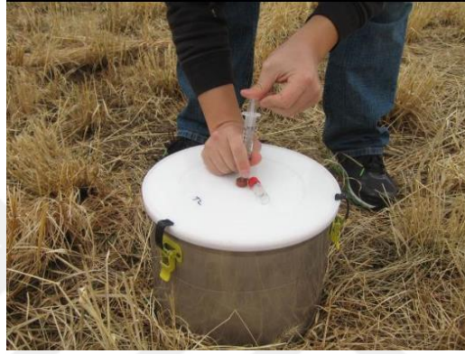
Şekil 2.4. Yüzeyden gaz örneklemesinde kullanılan örnek bir statik hazne (Kahmark vd., 2020)
