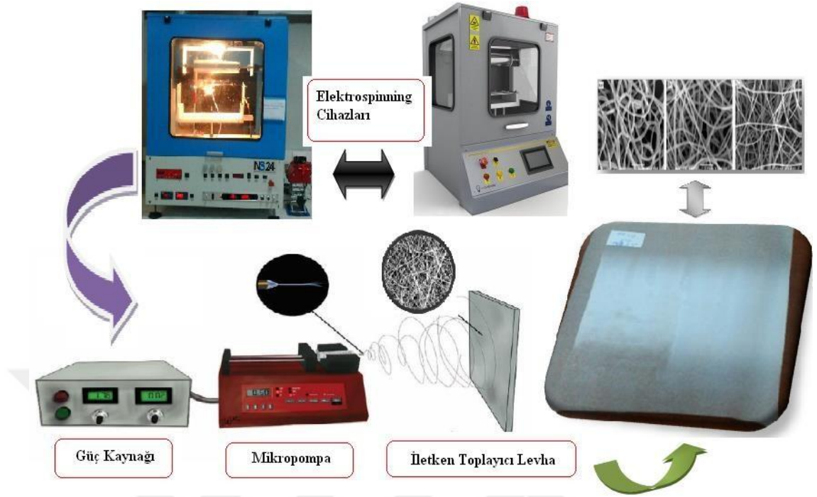
Şekil 4.4. Elektrospinning yöntemiyle biyokompozit üretimi aşamaları
