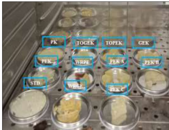
Şekil 49. Çalışma kapsamında TYÇB üretiminde kullanılan bağlayıcı reçinelerin 200 °C öncesi görünüşü
