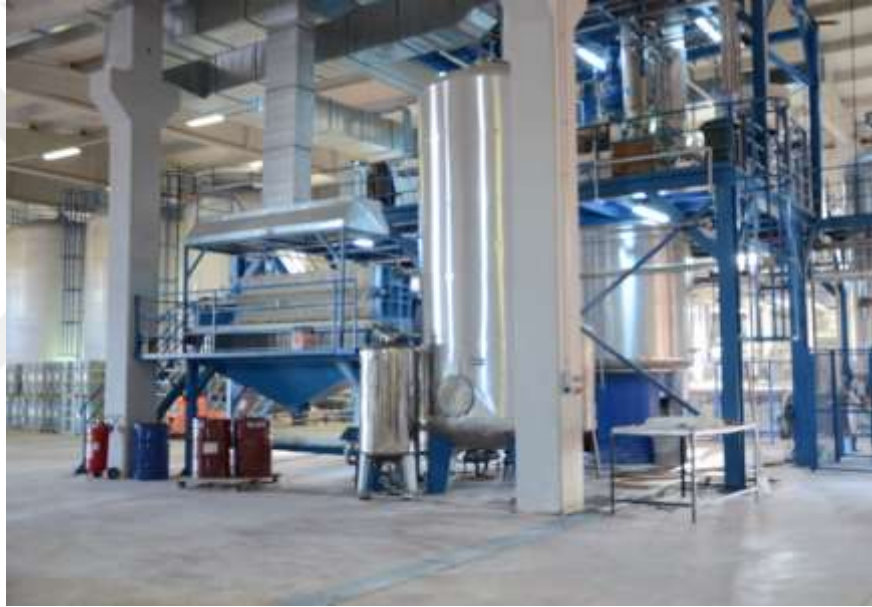
Şekil 15. Çam reçinesi destilasyon sistemi (URL-1, 2022)
