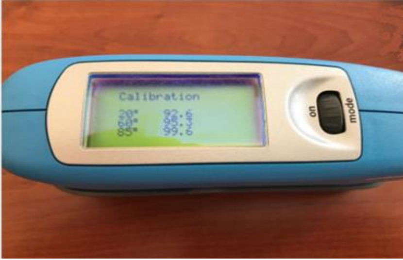
Şekil 3.11. Vernik ve boya katmanı parlaklık ölçüm cihazı (Gloss-metre)
