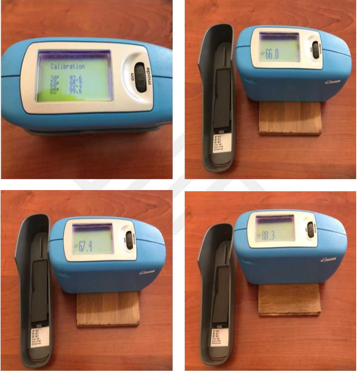
Şekil 7.11. Deneylerde kullanılan parlaklık ölçüm cihazı kalibrasyonu ve ölçüm uygulamaları
