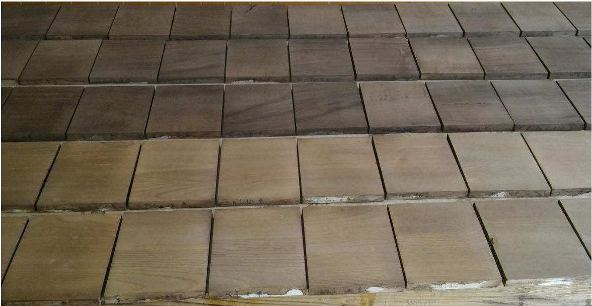
Şekil 7.4. Fırça ile 3 kat ceviz taneni uygulanmış sarıçam (önde, açık renkli) ve ceviz (arkada, koyu renkli) deney parçaları
