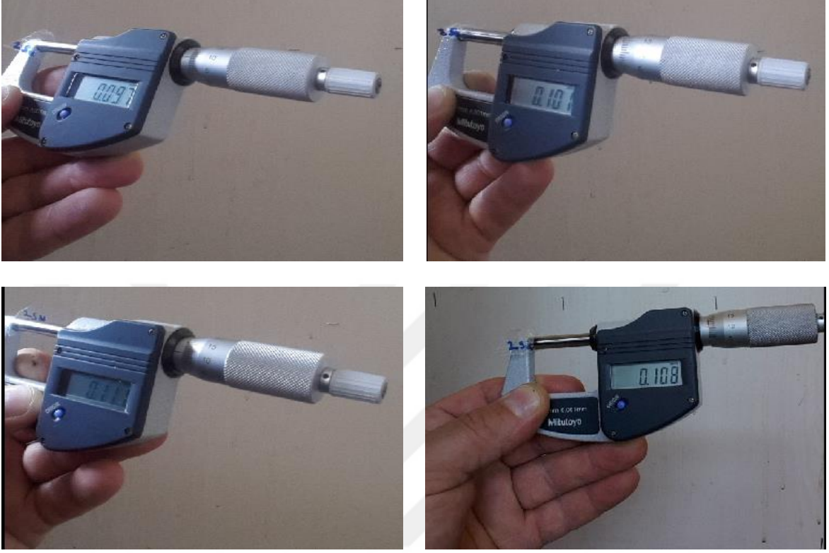
Şekil 7.8. Dijital mikrometre ile yapılan, su bazlı vernik film kalınlığı ölçümleri
