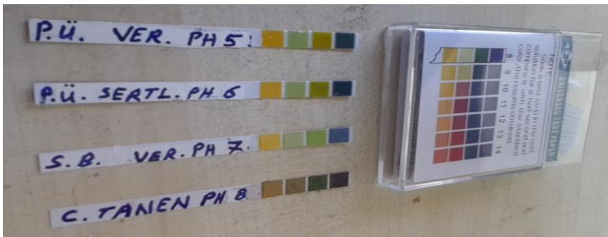
Şekil 3.5. pH metre kâğıdı ile yapılmış ölçüm sonuçları
