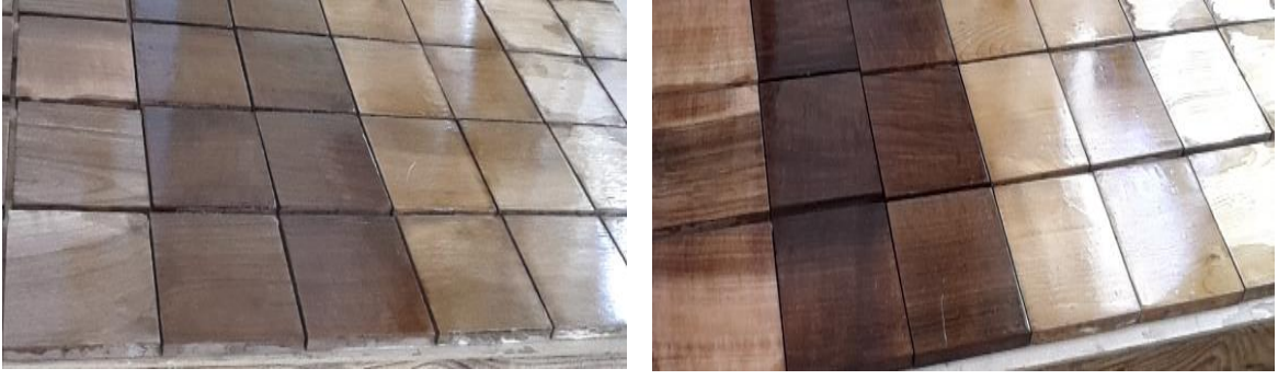
Şekil 3.3. Vernik uygulama resimleri (su bazlı vernik solda, poliüretan vernik sağda)
