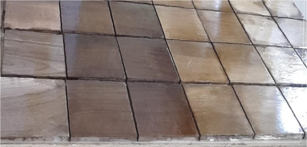
Şekil 7.6. 2 kat su bazlı vernik uygulanmış ceviz (solda, koyu renkli) ve sarıçam (sağda, açık renkli) deney parçaları
