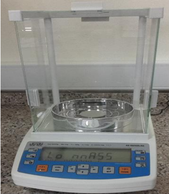
Şekil 3.9. Dijital hassas tartı ( d = \pm 0.001 gr)
