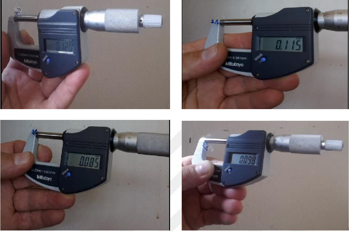
Şekil 7.7. Dijital mikrometre ile yapılan, poliüretan vernik film kalınlığı ölçümleri
