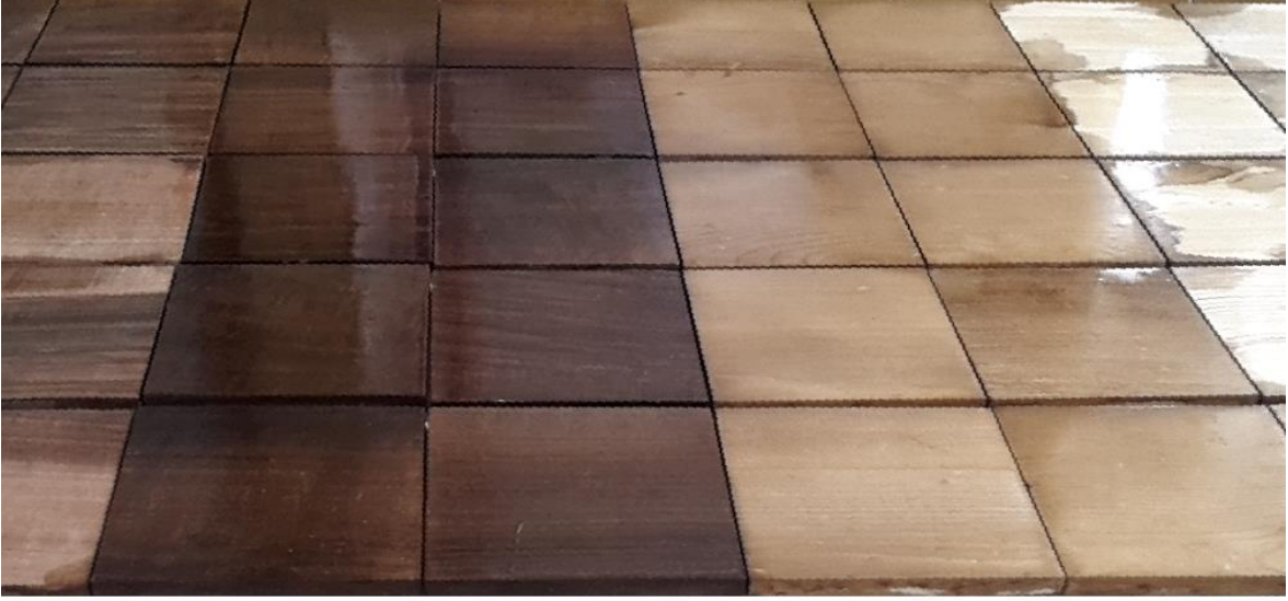
Şekil 7.5. 2 kat poliüretan vernik uygulanmış ceviz (solda, koyu renkli) ve sarıçam (sağda, açık renkli) deney parçaları
