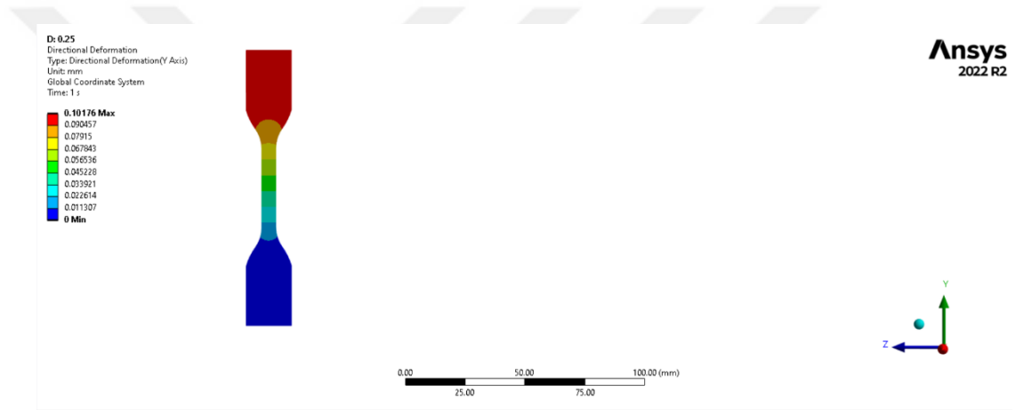
Şekil 7.11. %15 YFK takviyeli kompozit çekme testi sonucu
