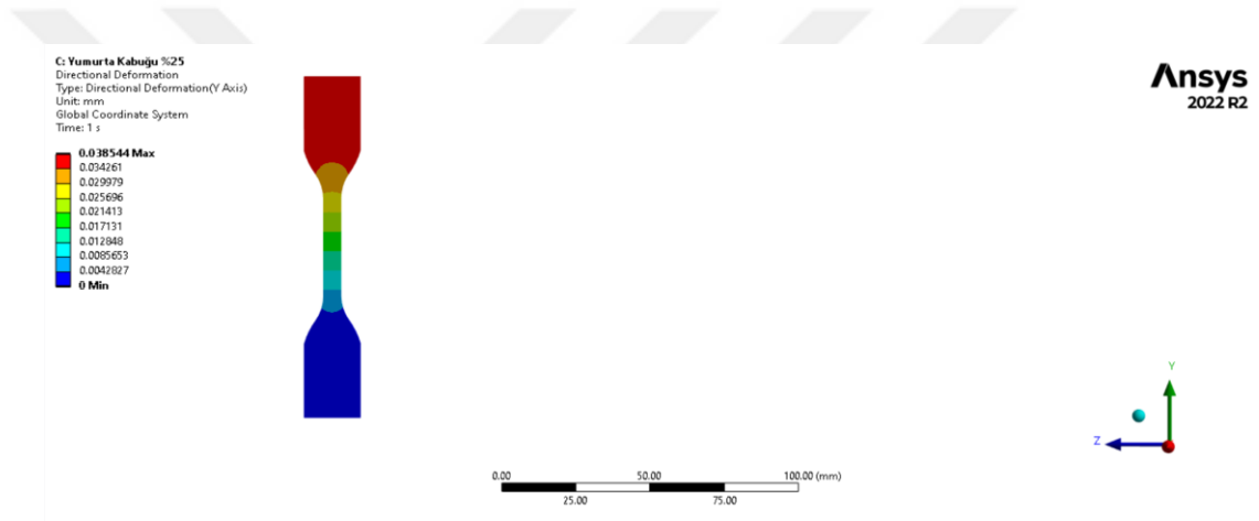
Şekil 7.14. %15 YK takviyeli kompozit çekme testi sonucu
