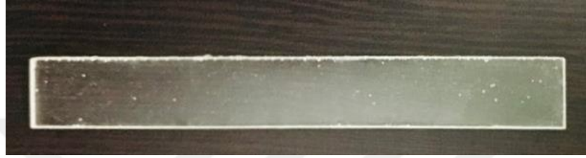
Şekil 5.11. Örnek 3 nokta eğilme numunesi
