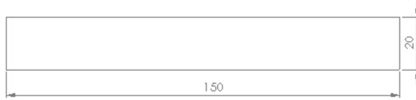
Şekil 5.14. Eğilme Testi Numunesinin Teknik Çizimi
