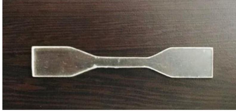
Şekil 5.9. Örnek çekme numunesi
