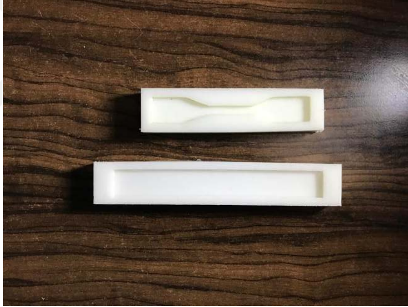
Şekil 5.2. Çekme ve üç nokta eğilme numunelerine ait silikon kalıpların görüntüsü
