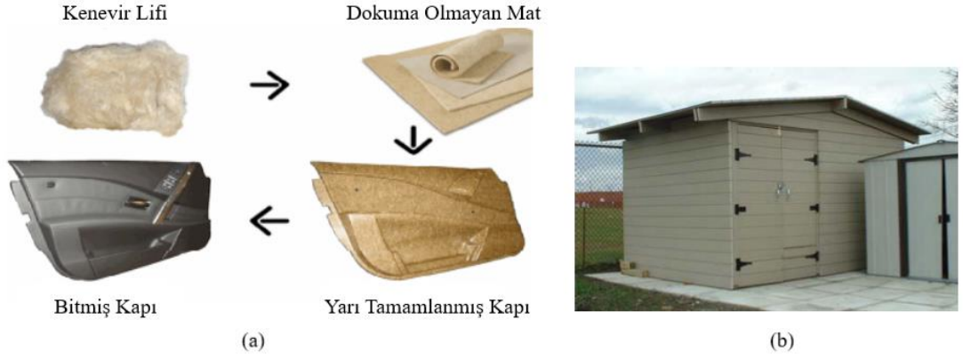
Şekil 3.5. Dokuma Kenevir Elyaf Kompozitinden Yapılmış Otomobil Kapısı (a), Dış cephede döşeme için kullanılan doğal lif görseli (b)
