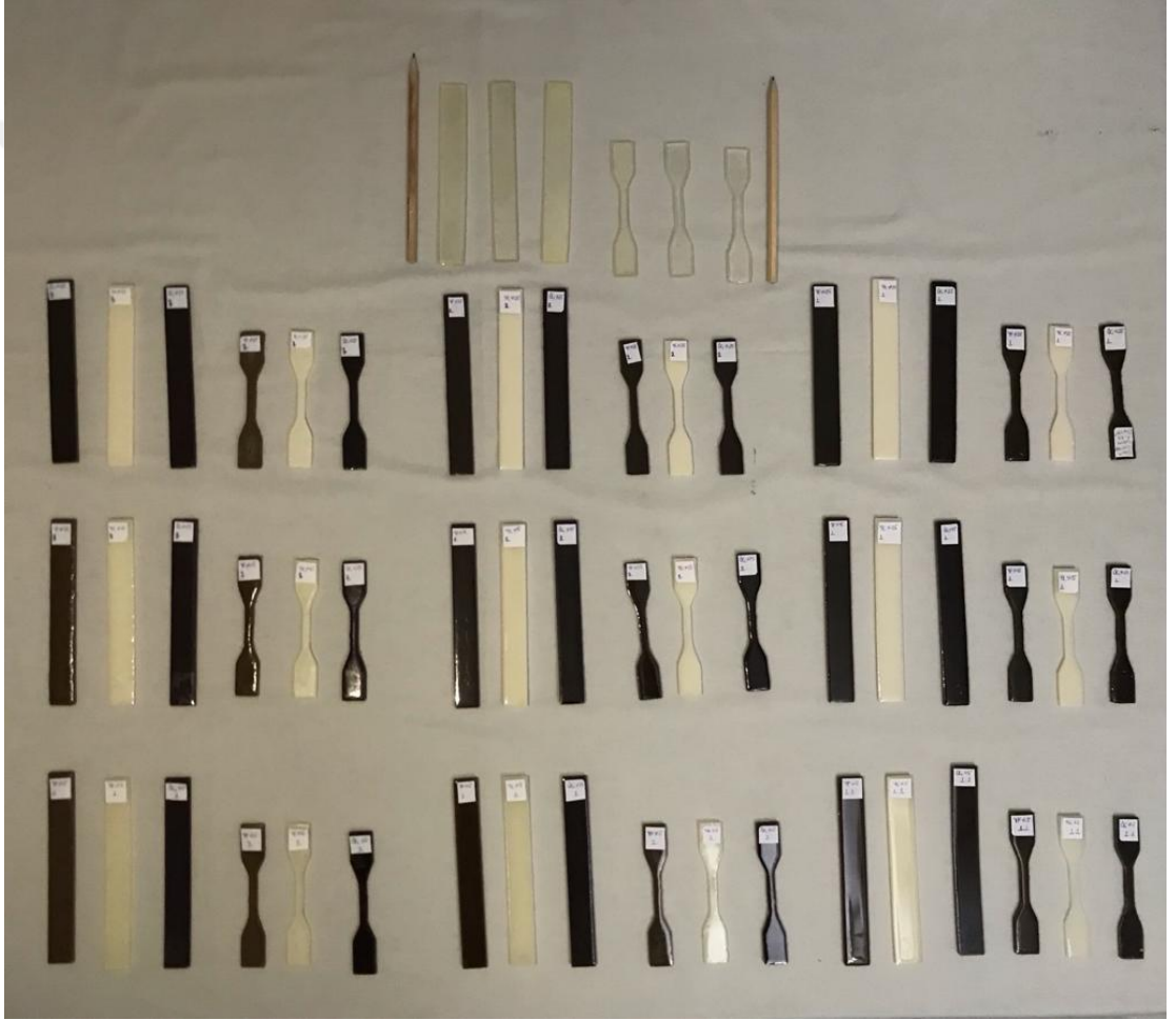
Şekil 5.7. Çekme, eğilme ve sertlik deney numuneleri
