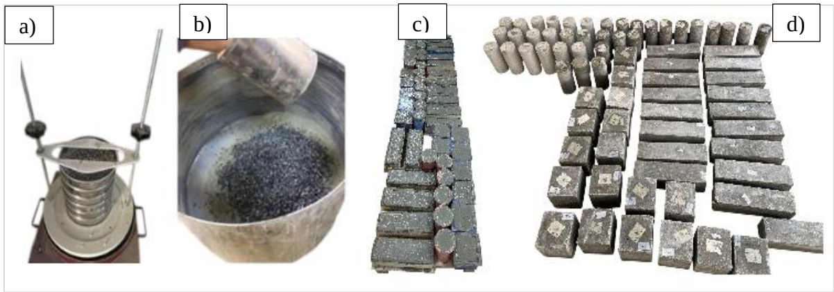
Şekil 11. Numune üretim süreci: a) elek analizi, b) laboratuvar tipi karıştırma işlemi, c) taze betonun kalıplara dökülmesi, d) kalıptan çıkarılmış numuneler ve e) kür edilmiş küp, kiriş ve silindirik numuneleri.
