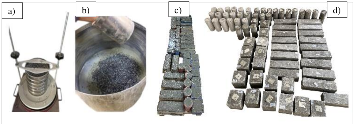
Şekil 11. Numune üretim süreci: a) elek analizi, b) laboratuvar tipi karıştırma işlemi, c) taze betonun kalıplara dökülmesi, d) kalıptan çıkarılmış numuneler ve e) kür edilmiş küp, kiriş ve silindir numuneleri.
