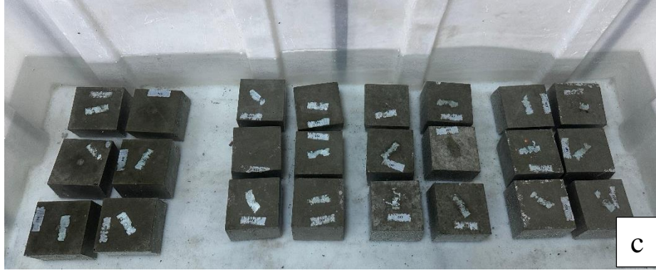
Şekil 3.3. a) Mikser, b) Üretilen Betonların Kalıplara Yerleştirilme İşlemi, c) Küp Numunelerin Kürleme İşlemi
