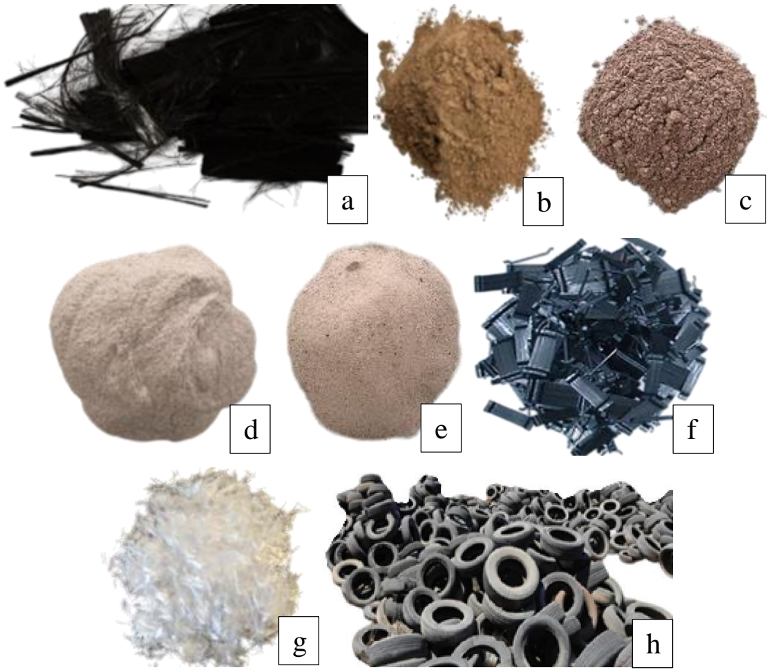
Şekil 2.11. a) Karbon Elyaf Lif (Bayrak ve diğ, 2021), b) Uçucu Kül (Ağırman ve diğ, 2024), c) yüksek Fırın Cürufu (Ağırman ve diğ, 2024), d) Atık Mermer Tozu (Ağırman ve diğ, 2024), e) Kuvarz Tozu (Ağırman ve diğ, 2024), f) Çelik Lif (Çelikel ve diğ, 2019), g) Polipropilen Lif (Çelikel ve diğ, 2019), h) Atık Kauçuk (Beiram ve diğ, 2022)
