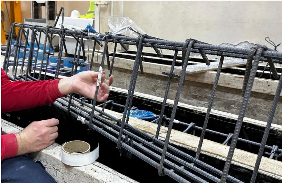
Şekil 3.13. Strain-Gauge Yapıştırılma İşlemleri
