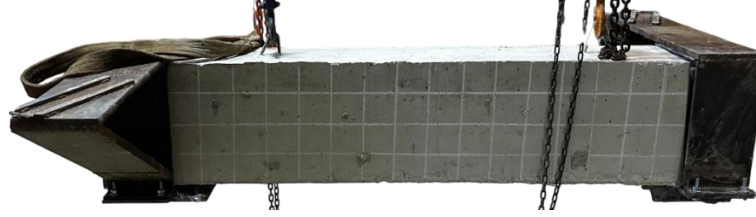
Şekil 3.21. Karelaj İşlemleri Tamamlanıp Deneye Hazır Hale Getirilen Kiriş Numunesi
