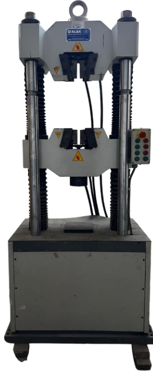
Şekil 3.7. Donatı Çekme Cihazı
