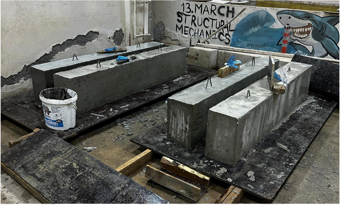
Şekil 3.18. Kalıpları Açılan Kiriş Numuneleri Kürleme İşlemleri
