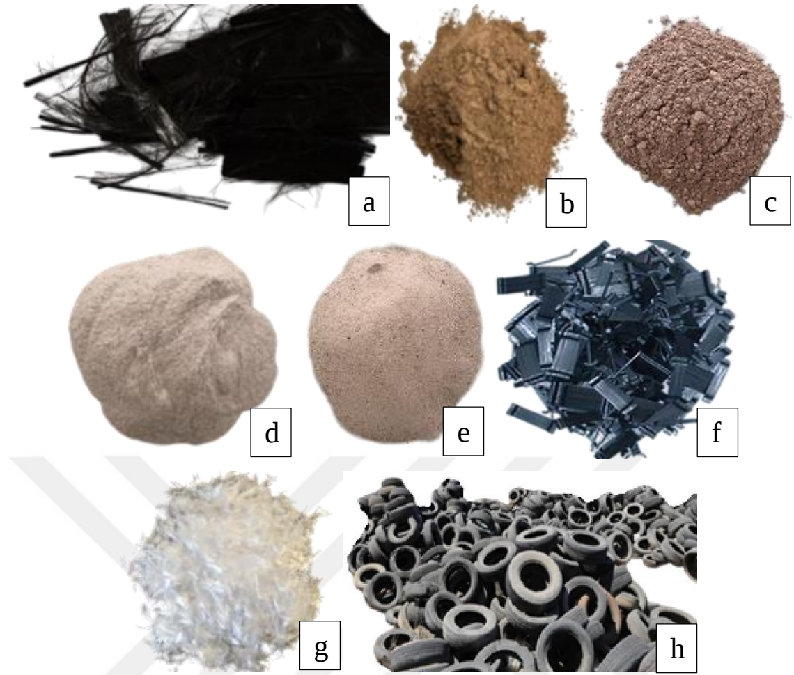
Şekil 2.11. a) Karbon Elyaf Lif (Bayrak ve diğ, 2021), b) Uçucu Kül (Ağırman ve diğ, 2024), c) yüksek Fırın Cürufu (Ağırman ve diğ, 2024), d) Atık Mermer Tozu (Ağırman ve diğ, 2024), e) Kuarz Tozu (Ağırman ve diğ, 2024), f) Çelik Lif (Çelikel ve diğ, 2019), g) Polipropilen Lif (Çelikel ve diğ, 2019), h) Atık Kauçuk (Beiram ve diğ, 2022)
