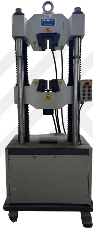
Şekil 3.7. Donatı Çekme Cihazı
