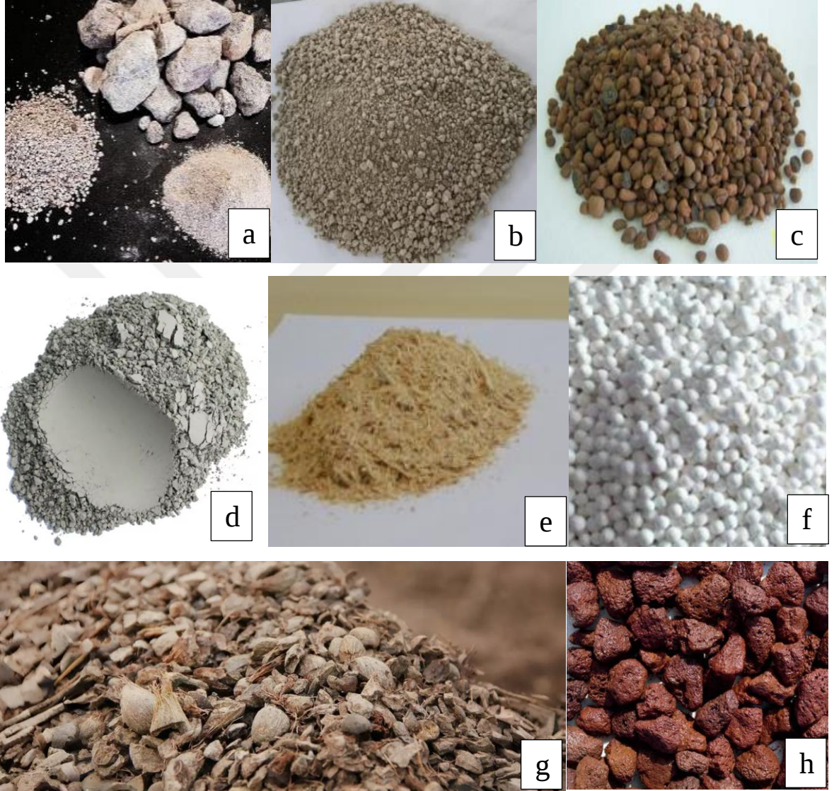
Şekil 2. 1. a) Perlit (Topuz ve diğ, 2022), b)Pomza (Geldim ve diğ, 2024), c) Genleştirilmiş Kil Agregası (Subaşı ve diğ, 2009), d) Uçucu kül (Aker Kimya) e) Pirinç Kabuğu (Gülyaprak ve diğ, 2019), f) Genleştirilmiş Polistiren Köpük (Canbaz ve diğ, 2022), g) palmiye çekirdeği kabuğu, h) Volkanik Tuf (Aydınlar Madencilik)
