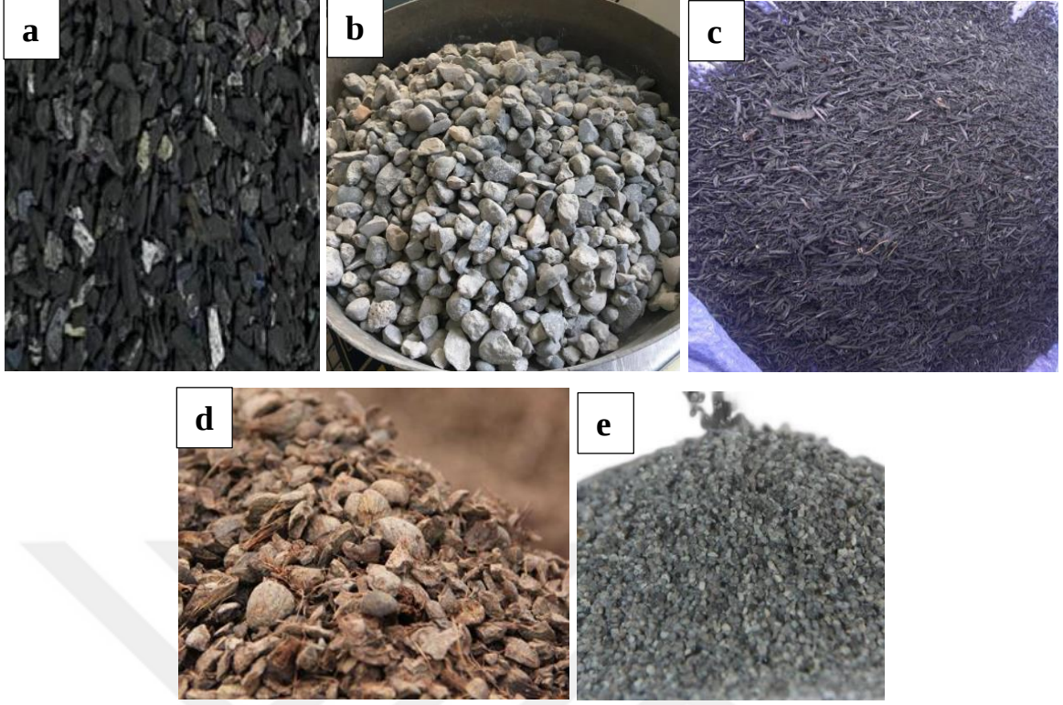
Şekil 1.4. a) E-Atık (Bulut ve diğ, 2024), b) Geri Dönüştürülmüş Agrega (Akkaya ve diğ, 2024), c) Kauçuk (Muhaimin ve diğ, 2015), d) Palmiye Kabuğu (Purwanti ve diğ, 2018), e) Doğal Perlit (Korkmaz ve diğ, 2024)
