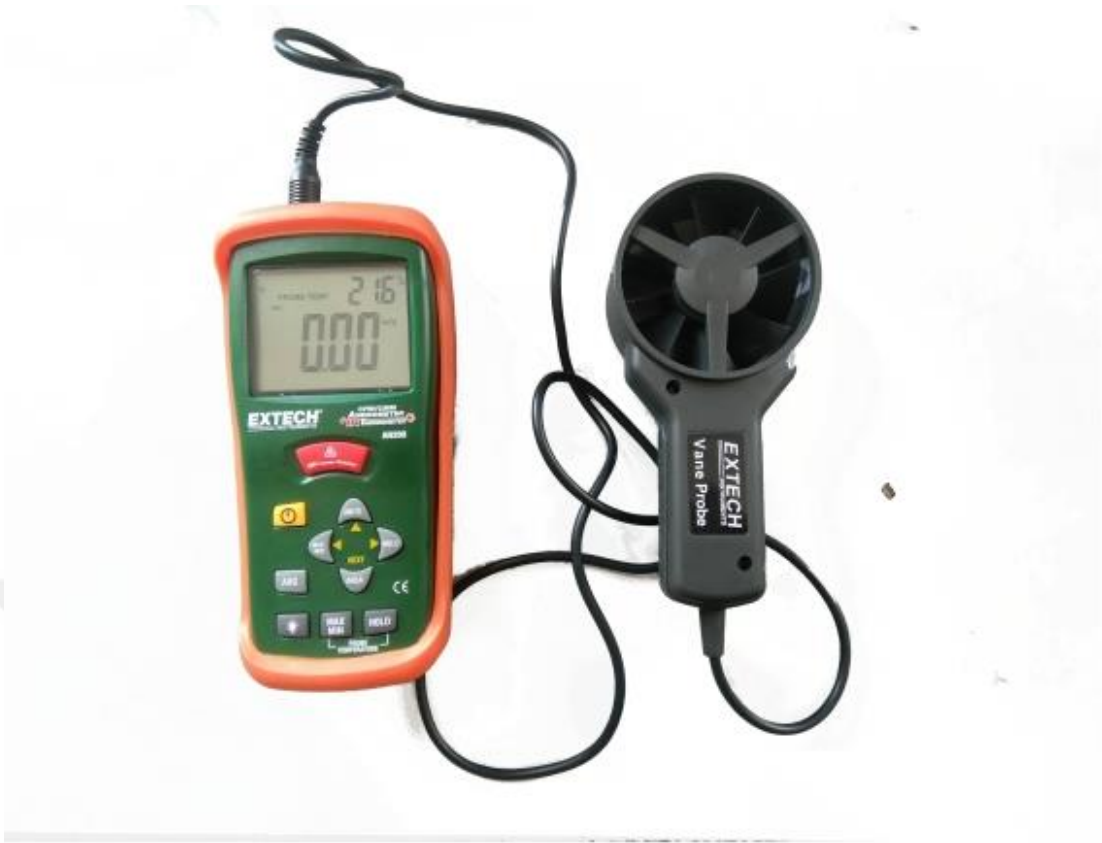
Şekil 3.26. Rüzgâr hızının ölçülmesi için kullanılan cihaz
