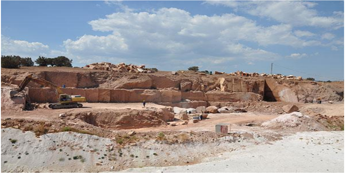
Şekil 5. Alimoğlu marble çukur rampalı açık ocak işletmesi
