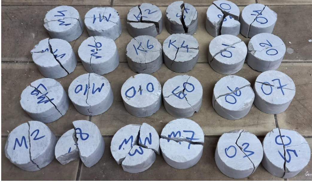
Şekil 4.4. Kayaç örneklerine ait nokta yükleme deneyi sonrası görüntüler
