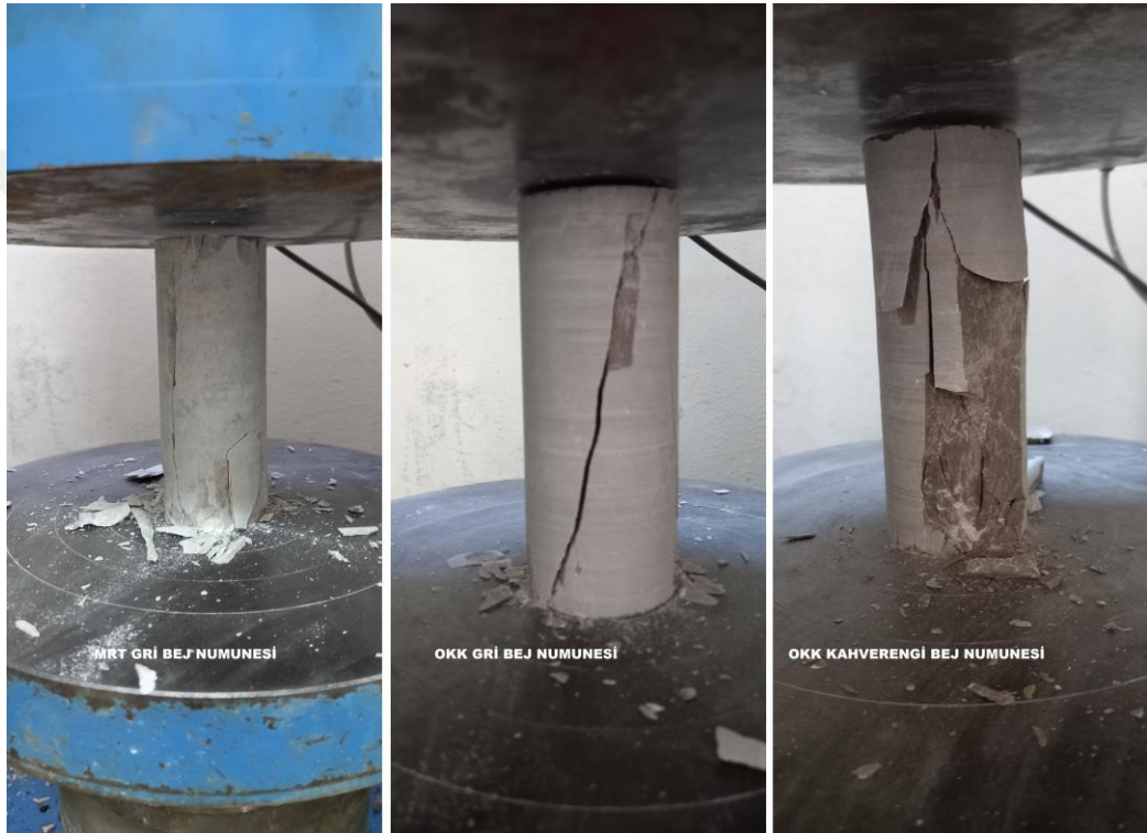
Şekil 4.2. Kayaç örneklerine ait tek eksenli basınç deneyi sonrası numunelerin görünümü
