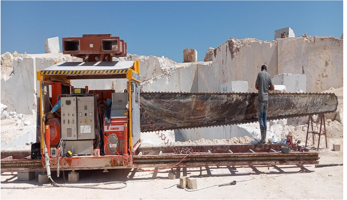
Şekil 3.3. OKK Madencilik Alibeyhüyüğü ocağında kullanılan Fantini 70-SUPER-Hmodel zincirli kesme makinesi
