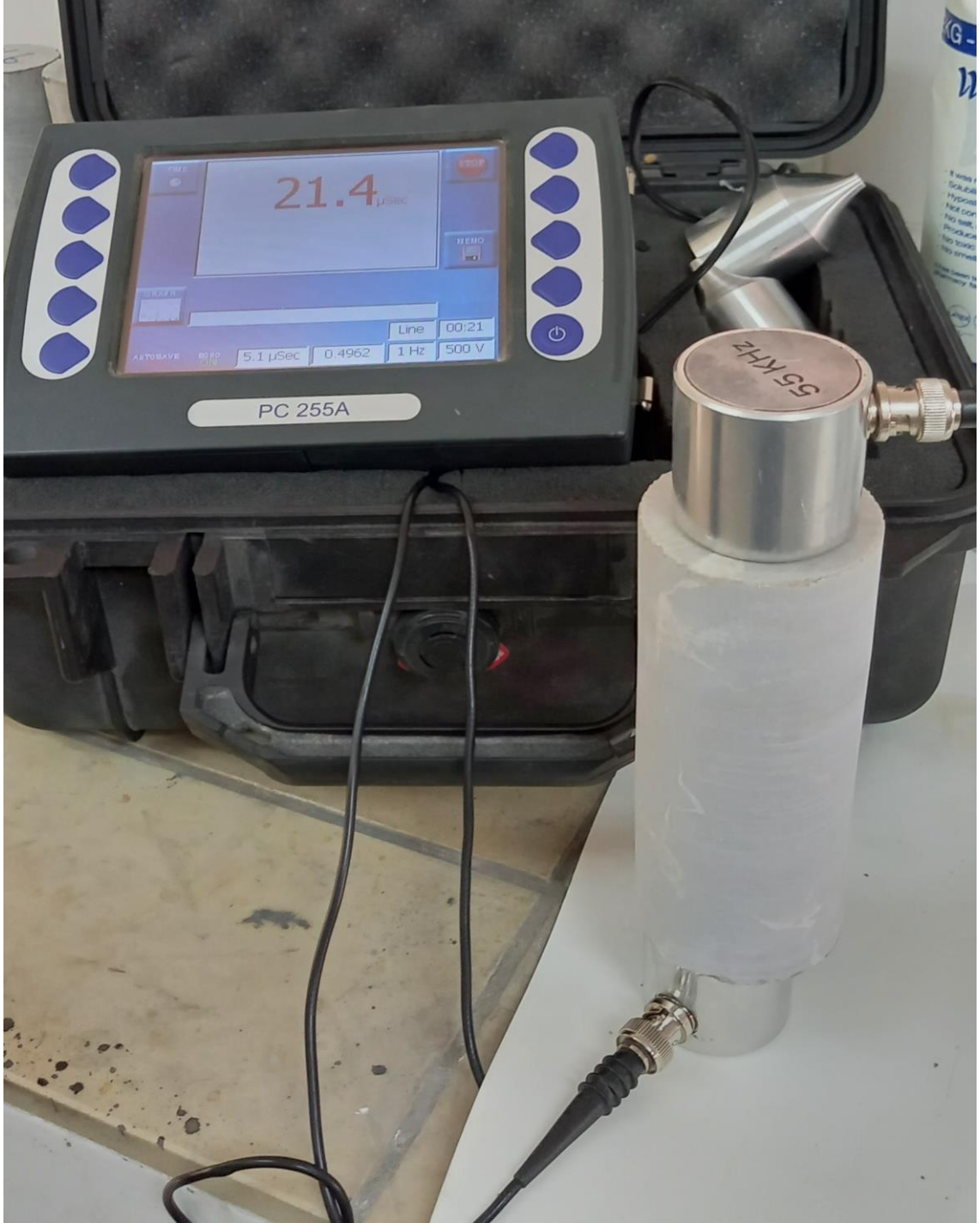
Şekil 4.3. Kayaç numunelerinde sonik hız deneyinin yapılışı
