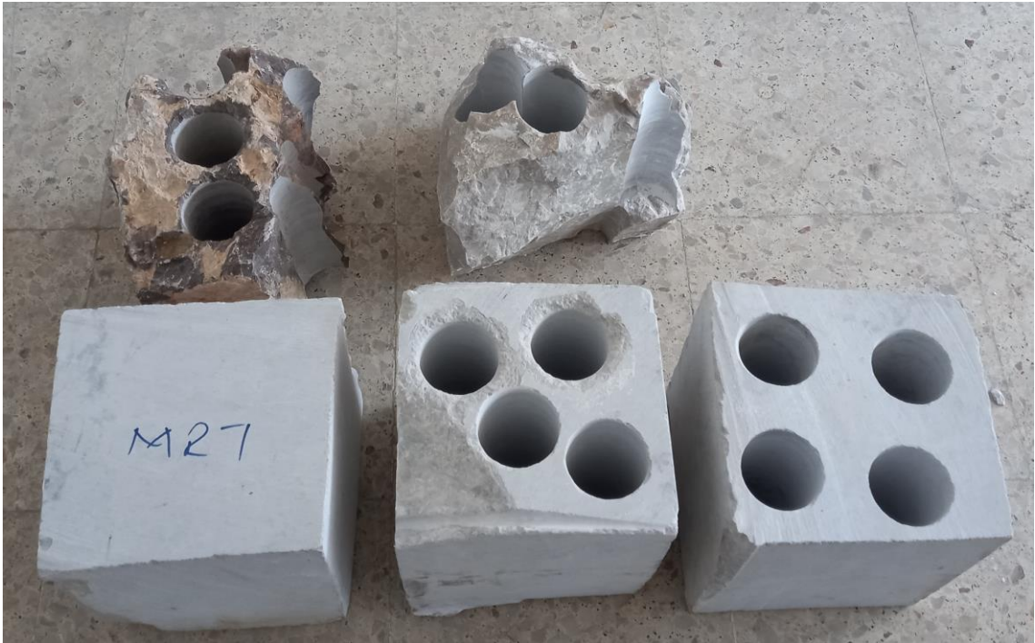
Şekil 3.7 Karot numuneleri hazırlamak için kullanılan blok şeklinde kayaç örnekleri
