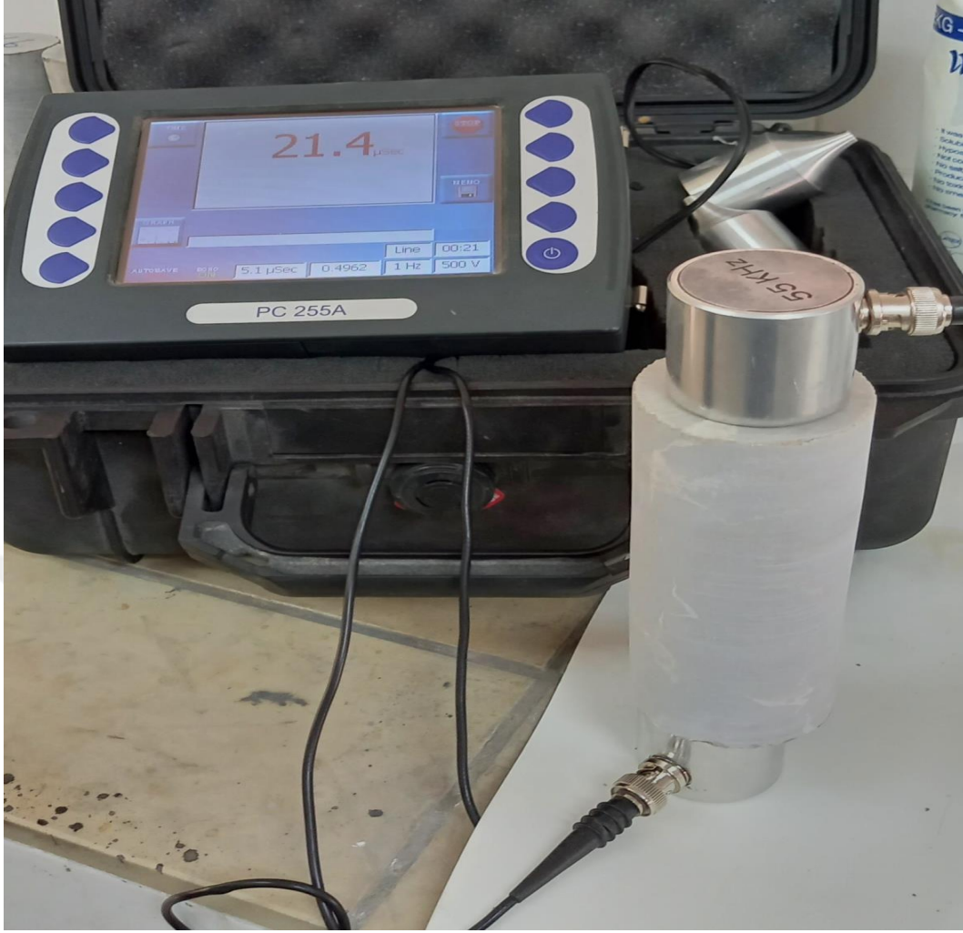
Şekil 3.15. Kayaçların P dalga hızını belirlemek için kullanılan MATEST sonik cihazı
