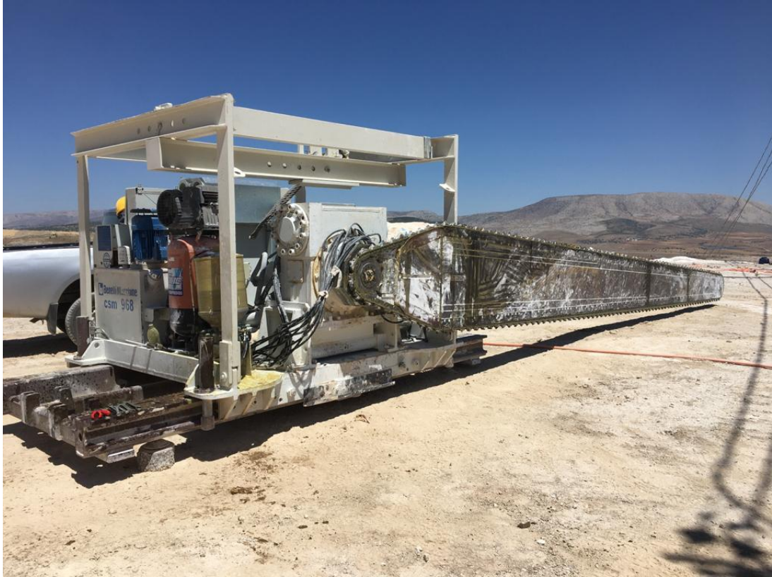
Şekil 3.2 MRT Çayırbağı ocağında kullanılan Benetti CSM 968 model zincirli kesme makinesi
