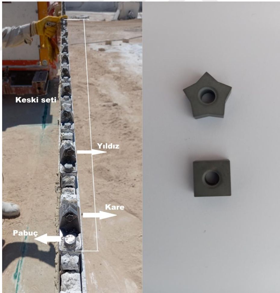
Şekil 3.5. Fantini 70 SUPER-H zincirli kesme makinesi kullanılan keski ve keski seti
