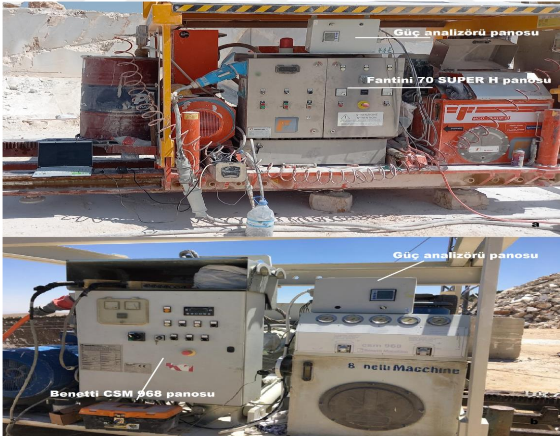
Şekil 3.21. Güç analizörü için hazırlanan panonun zincirli kesme makinelerinin elektrik panolarına bağlantısı
