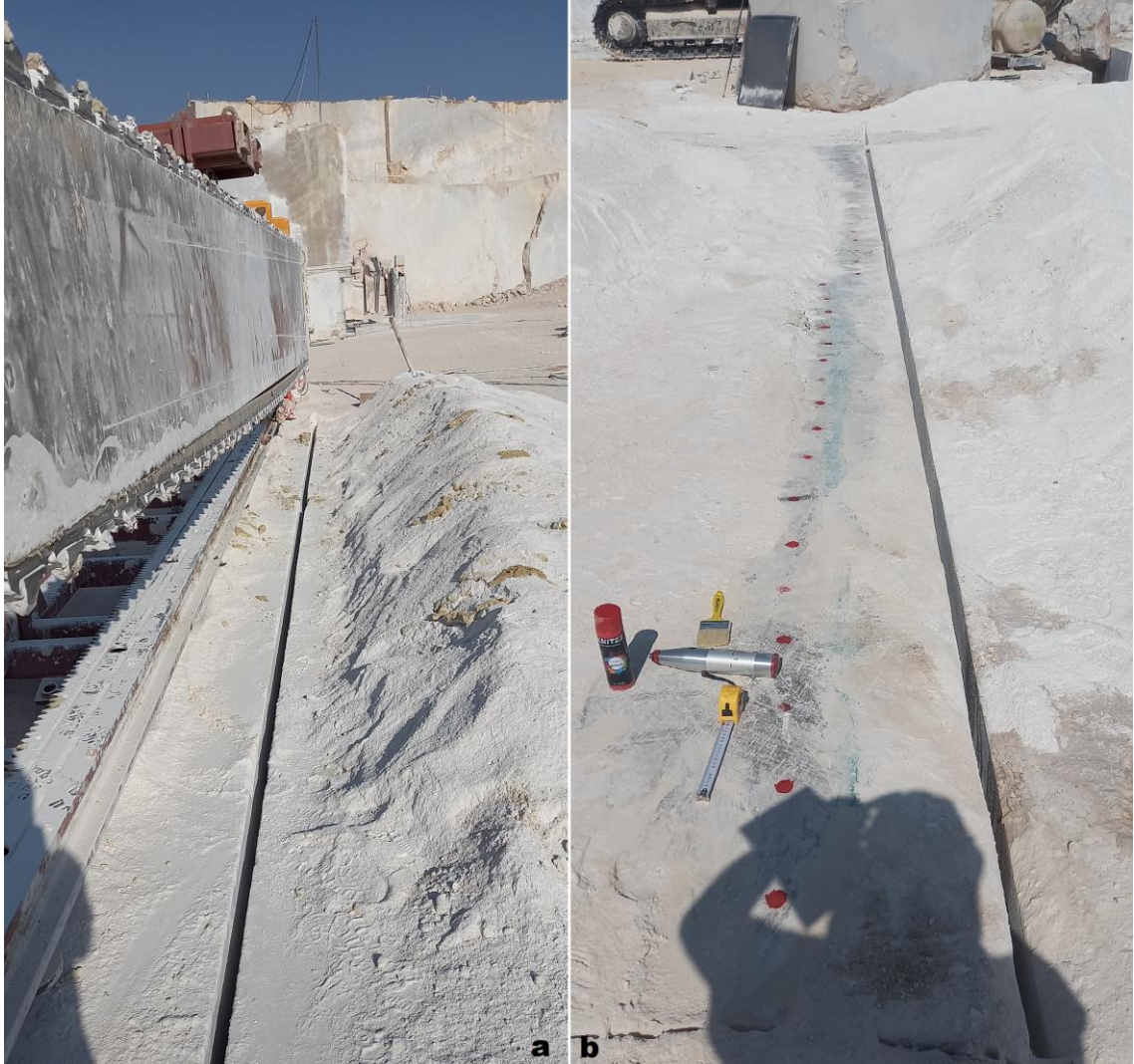
Şekil 3.14. Fantini 70 SUPER-H zincirli kesme makinesinin kesim yaptığı hat boyunca (a) her 20 cm de yapılan sistematik Schmidt çekici sertlik deneyleri (b)
