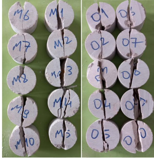
Şekil 4.1. MRT gri bej ve OKK gri bej kayaç numunelerinin dolaylı çekme deneyi sonrası görünümü
