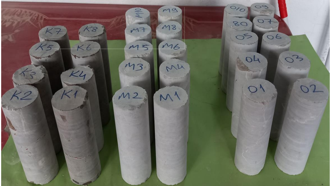
Şekil 3.8. Tek eksenli basınç deneyi için hazırlanmış tipik karot numuneleri
