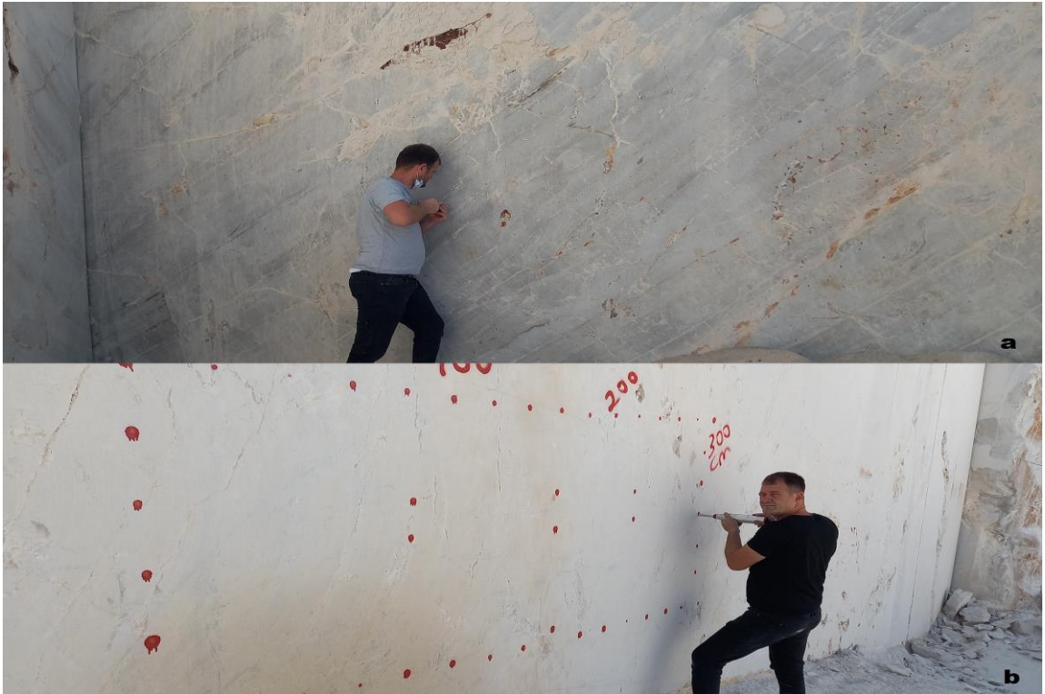
Şekil 3.13. OKK madencilik Kavak (a) ve Alibeyhüyüğü (b) ocaklarında basamaklarda yapılan Schmidt çekici sertlik deneyleri
