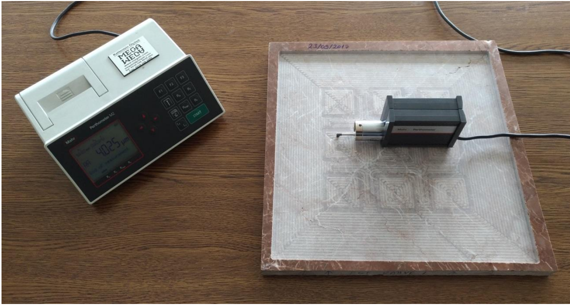
Resim 2.2 Mahr Perthometer M2 model yüzey pürüzlülük ölçüm cihazı.
