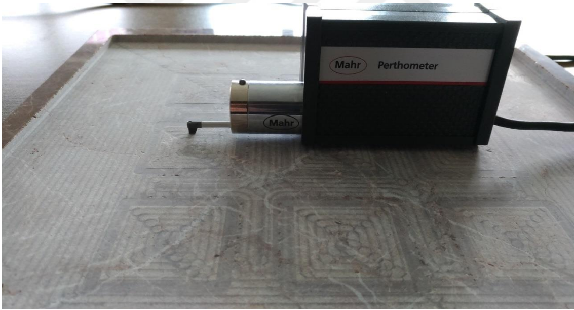
Resim 3.22 Örnek yüzey pürüzlülük ölçümü.
