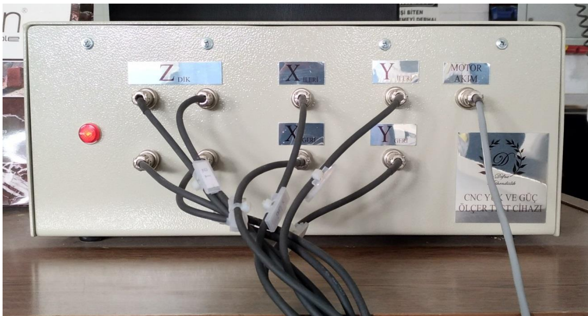
Resim 3.6 Yük ve güçleri ölçen veri toplama cihazı.
