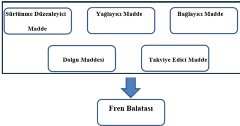
Şekil 2.1 Fren balatasını oluşturan temel bileşenler.
