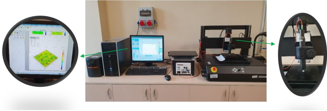
Resim 3. 23 Üç boyutlu profilometre cihazı.
