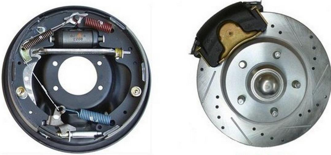
Resim 2.2 Kampanalı ve disk fren görünümü (İnt. Kyn. 4).
