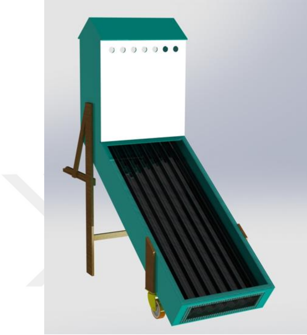
Şekil 3.4. Güneş enerjili kurutma sisteminin genel görünüşü.
