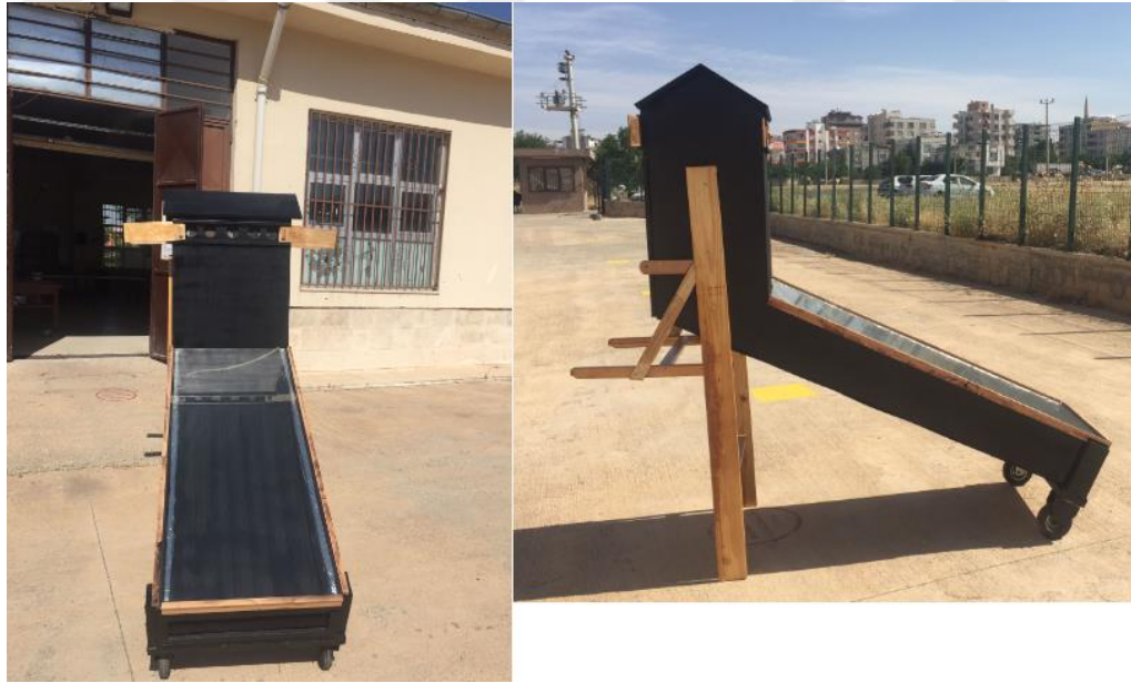
Şekil 3.12. Güneş enerjili kurutma sistemi.
