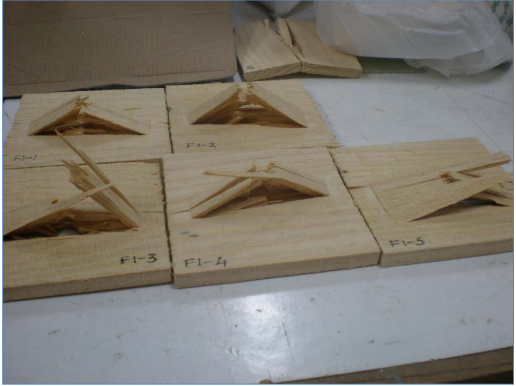
Şekil 6.27 Darbe deneyi sonrası ısıtılmış işlem görmüş çam örneklerinin durumu
