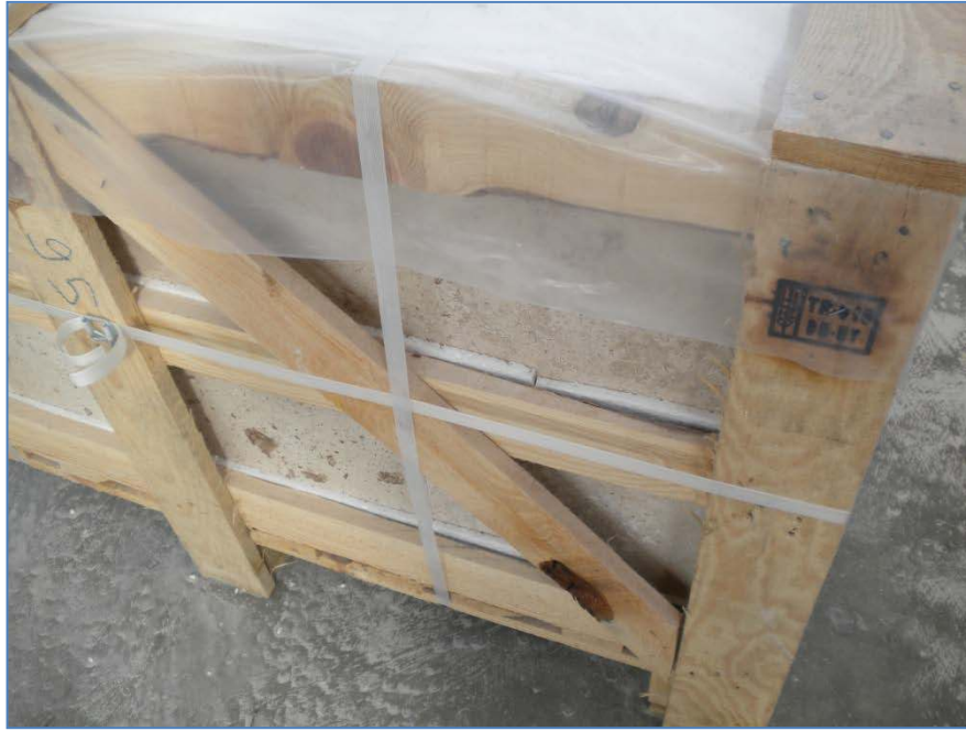
Şekil 5.2 Kasa üzerinde görülen ISPM 15 damgası
