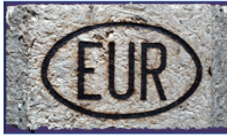
Şekil 5.5 Taşıyıcının Euro palet olduğunu gösteren damga
