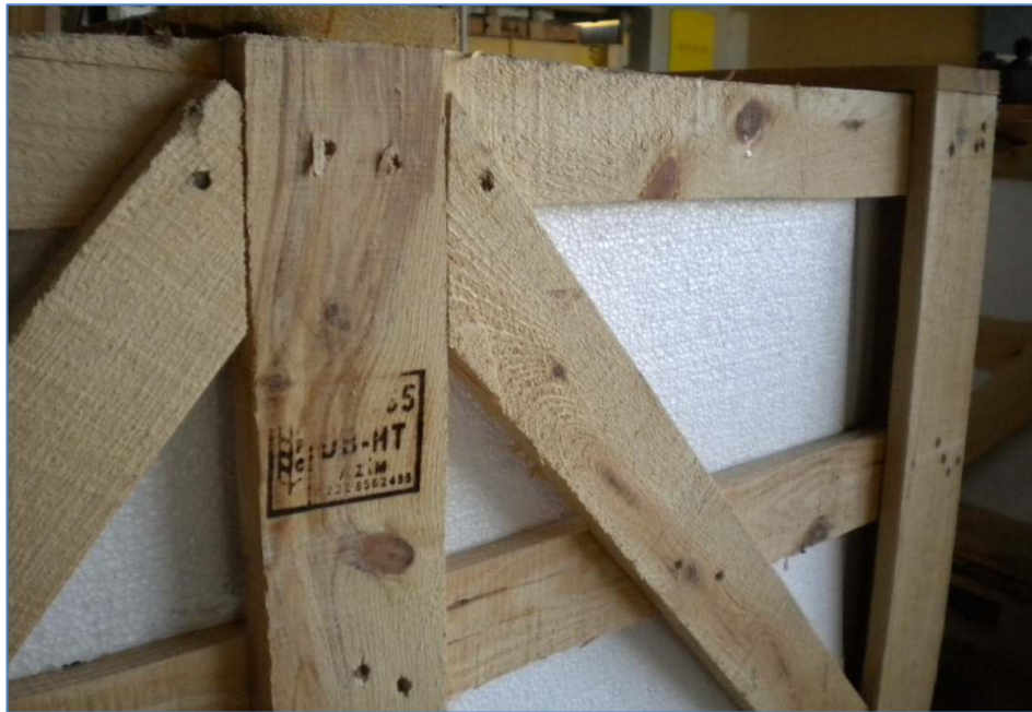
Şekil 6.14 ISPM standardına uygun olmayan, okunaksız damgalama
