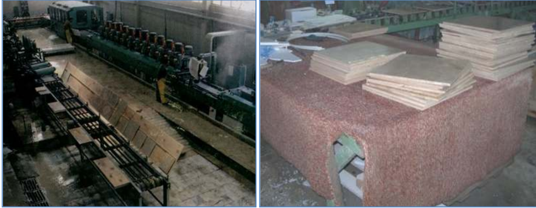
Şekil 3.14 Seleksiyon hattı, kalite kontrol ve seleksiyon masası
