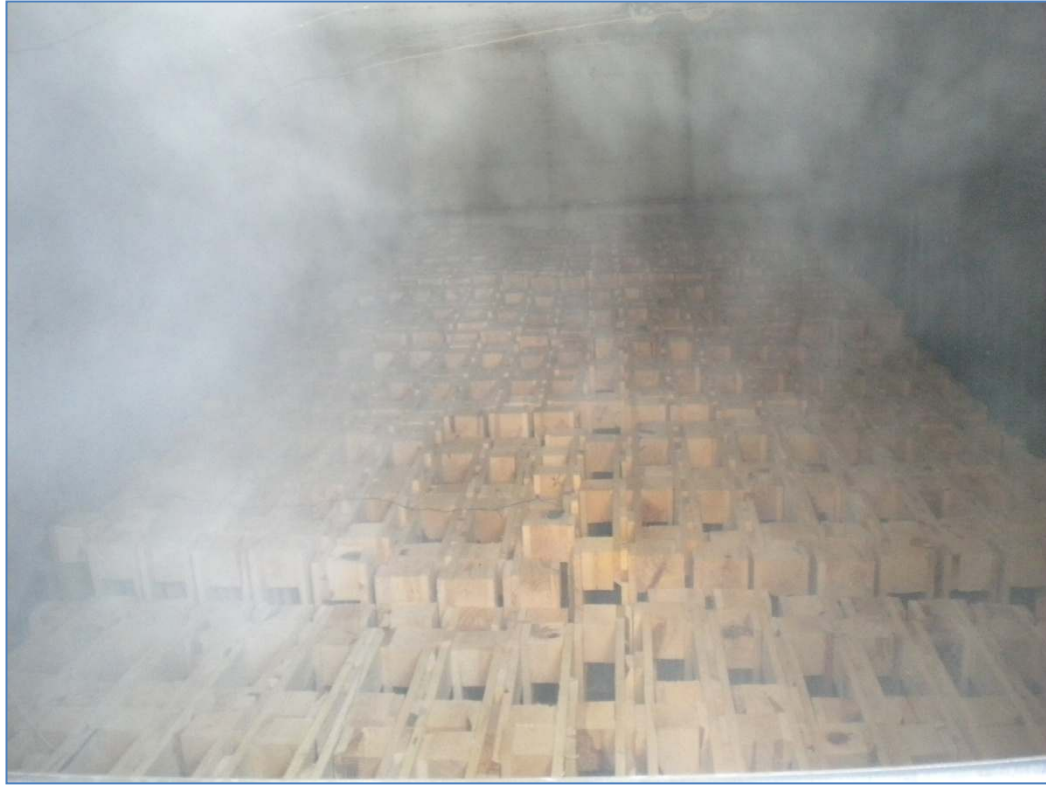
Şekil 6.8 Isıl işlem sırasında fırın içindeki paletler
