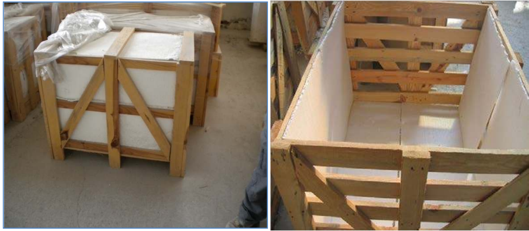
Şekil 3.27 Straforun doğal taş ambalajlamada kullanımı
