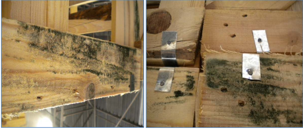
Şekil 6.9 İşlem sonrasında kasalarda mantar oluşumu
