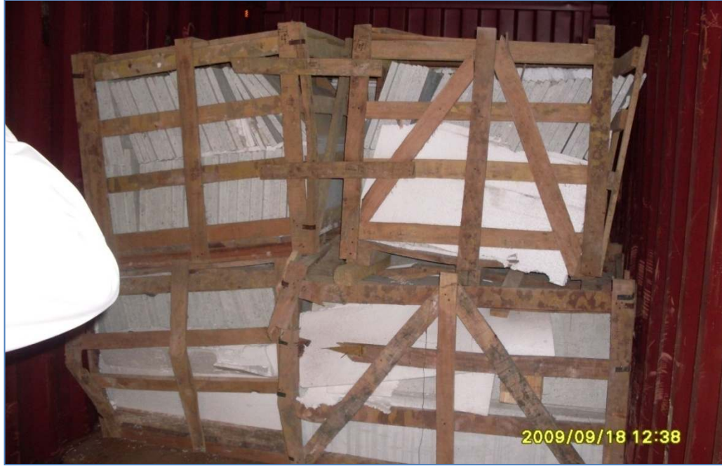
Şekil 6.6 Hatalı paketlenme nedeniyle hasar görmüş ürünler ve hasar görmüş ahşap ambalajlar (Angı, S., Kişisel görüşme, İstanbul Teknik Üniversitesi Jeoloji Mühendisliği Bölümü)
