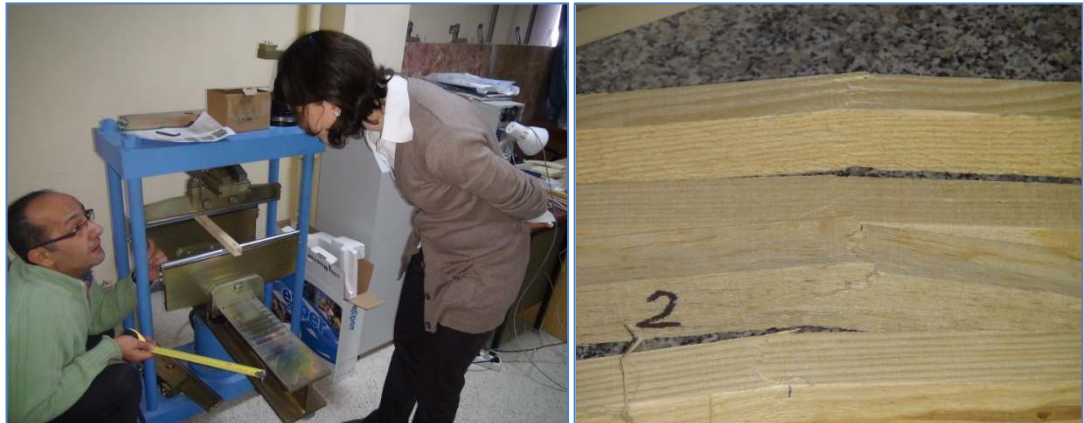
Şekil 6.22 Eğilme testi uygulaması ve sonucunda örneklerin durumu
