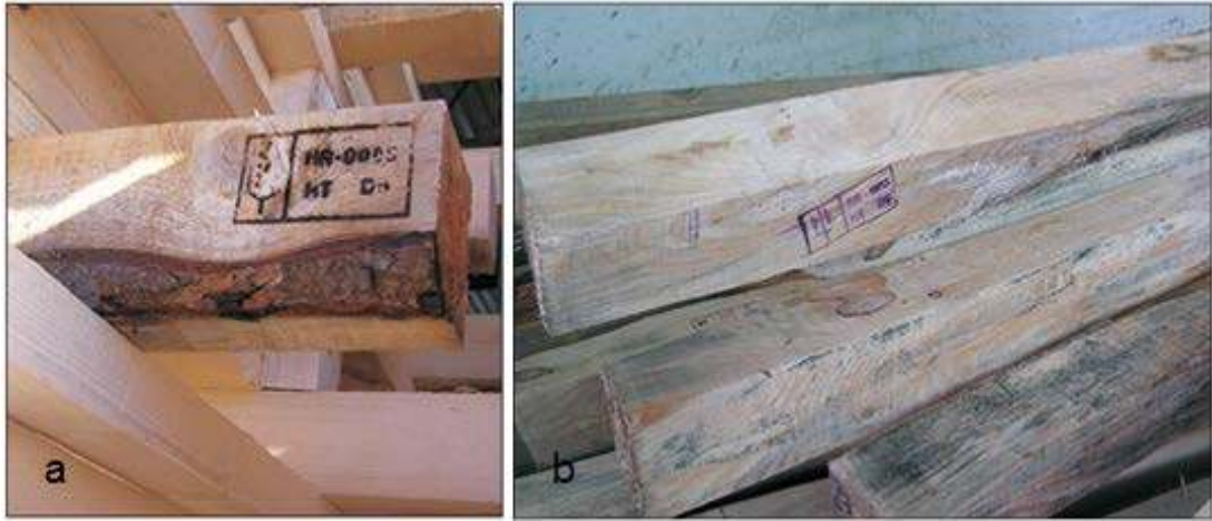
Şekil 6.13a. Paletler üzerinde fazla miktarda kabuk bulunması (Jambrekovic, Despot, Hasan, 2010)
