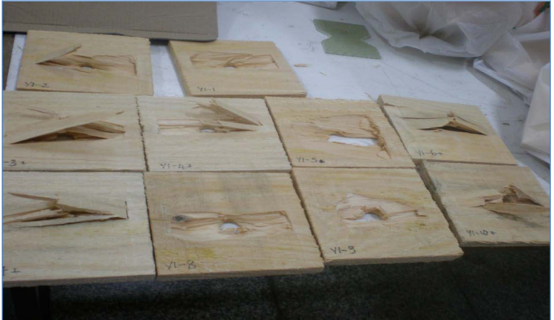
Şekil 6.28 Darbe deneyi sonrası ısıtılmış işlem görmemiş çam örneklerinin durumu
