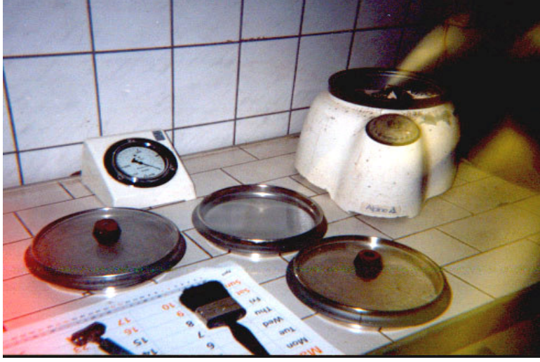
Resim 3.3. Alpine marka incelik ölçüm cihazı
