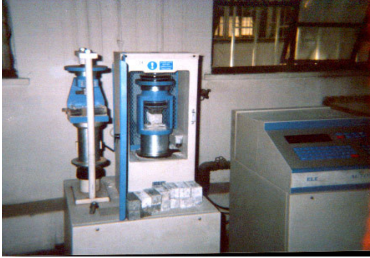
Resim 3.7. ELE Autotest 250 eğilmede çekme ve basınç deney cihazı
