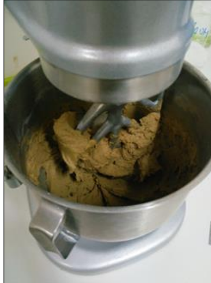
Şekil 12. Geopolimer malzemenin Hobart mikser ile hazırlanma aşaması.
