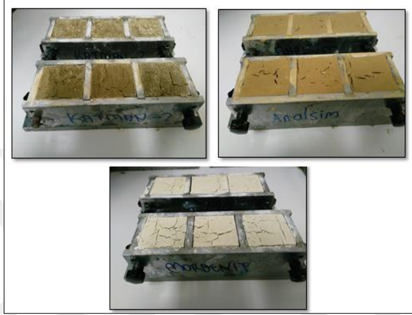
Şekil 13. Hazırlanan geopolimer malzemenin kalıplara dökülmesi.
