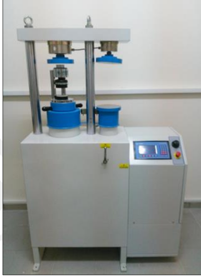
Şekil 15. 10 kN kapasiteli Utest çekme-basma cihazı.
