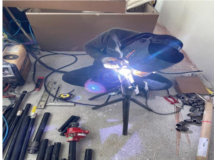
Şekil 1.11. Çok Küçük Tesisat Parçalarının Kaynak İşlemi (Tunç, 2024)
