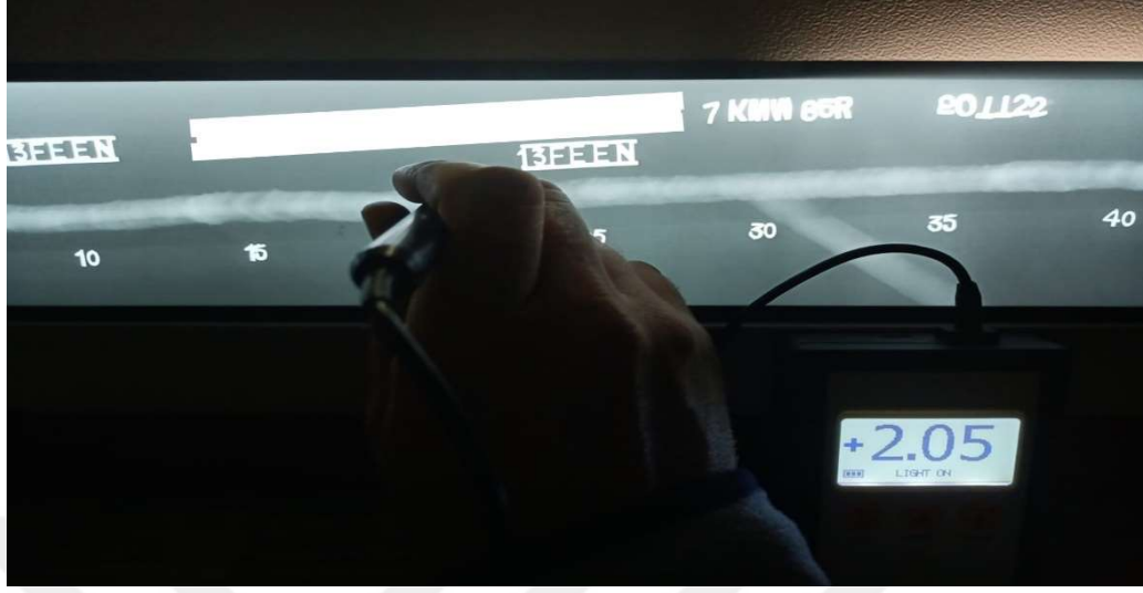
Fotoğraf 6.9. X-Ray Crawler ile Çekilmiş Filmin Yoğunluk Ölçümü.
