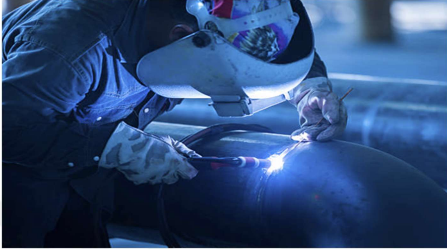
Şekil 3.6. TIG Kaynağı Uygulaması. (İnoks Lazer, 2022)
