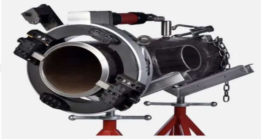
Şekil 4.1. Boru Kesme ve Kaynak Ağzı Hazırlama Ekipmanı. (Direct Industry, 2022)
