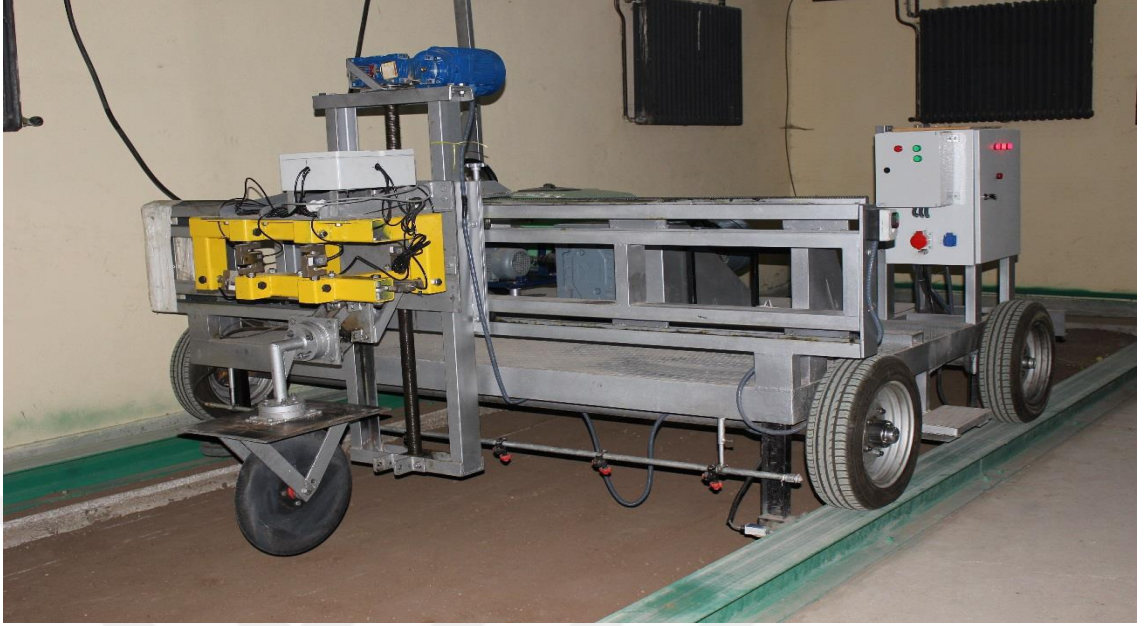
Şekil 3.1. Toprak kanalı ve kanal arabası
