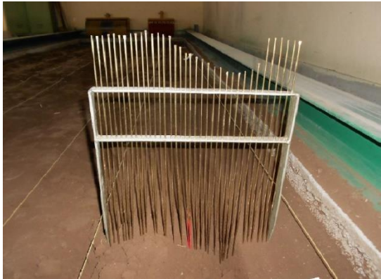
Şekil 3.11. Çizi profilini belirlemek amacıyla kullanılan profilograf
