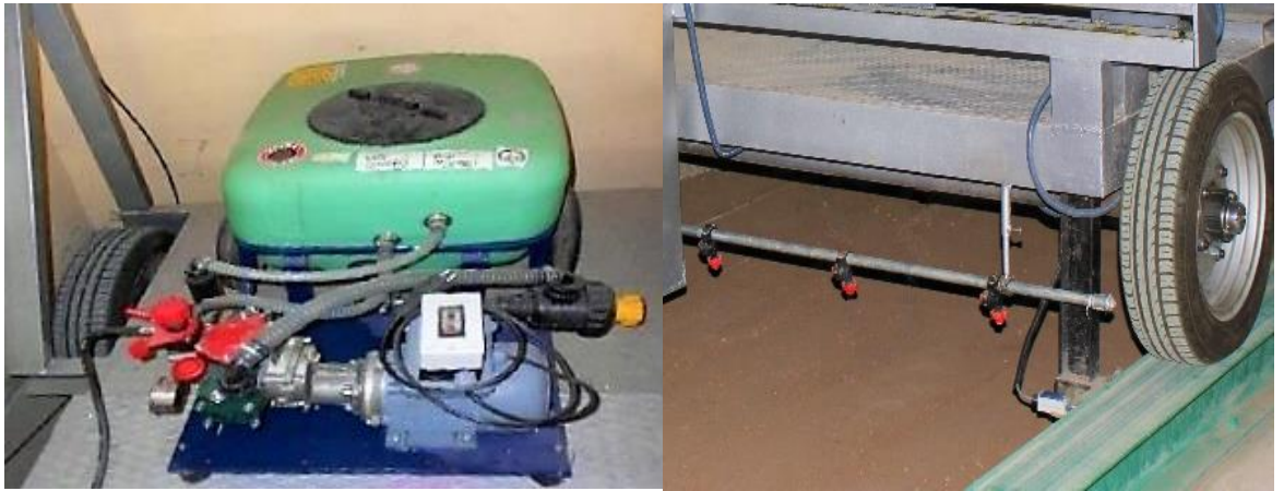
Şekil 3.3. Toprağın nemlendirilmesi için kullanılan pülverizatör ve püskürtme memeleri
