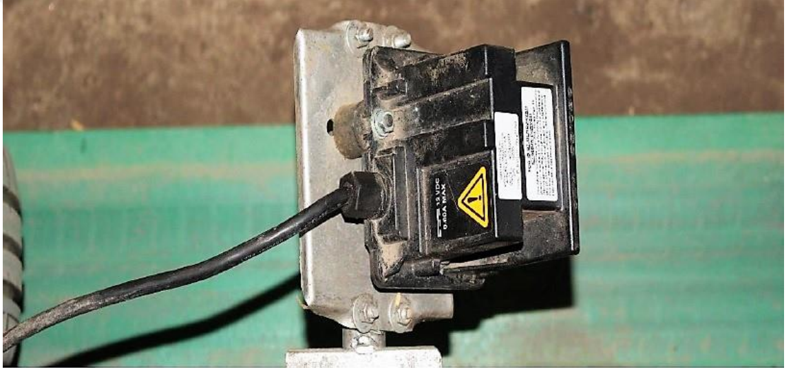
Şekil 3.14. İlerleme hızının belirlenmesinde kullanılan hız sensörü
