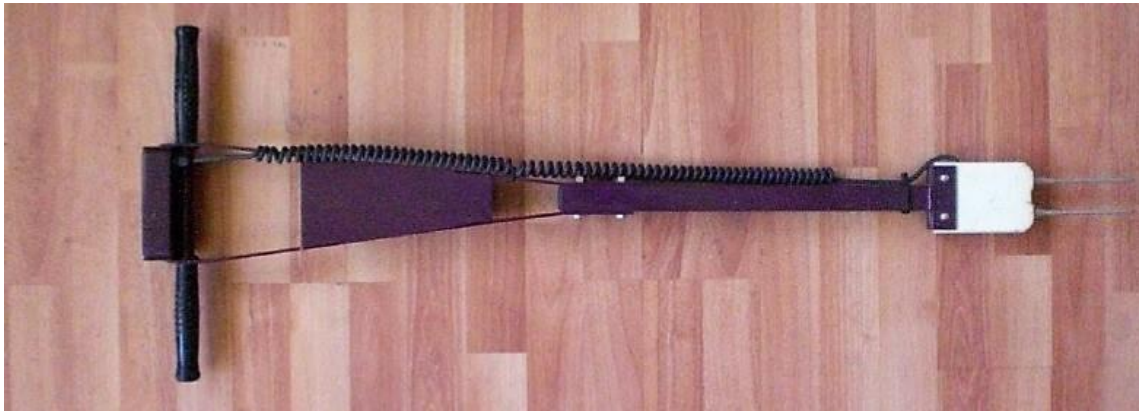
Şekil 3.7. TDR 300 toprak nemi ölçme cihazı
