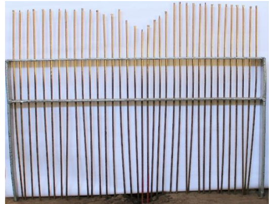
Şekil 3.11. Çizi profilini belirlemek amacıyla kullanılan profilograf
