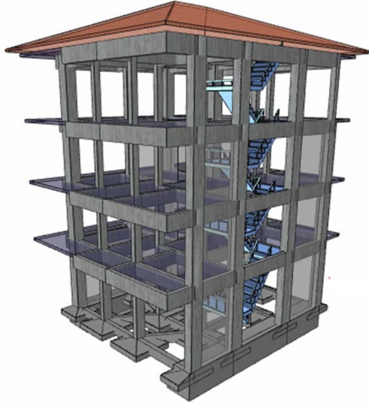
Şekil 5.38. Birinci güçlendirme önerisi 3 boyutlu görünüş
