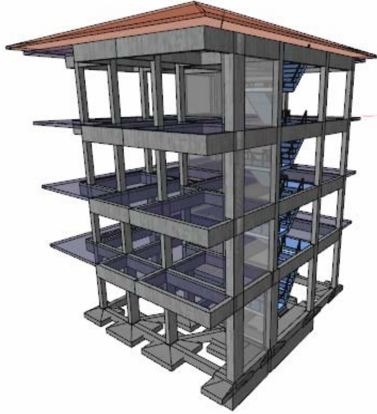
Şekil 5.58. Optimum güçlendirme önerisi 3 boyutlu görünüş
