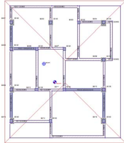
Şekil 5.30 İkinci güçlendirme önerisi 3.Normal kat kalıp planı
