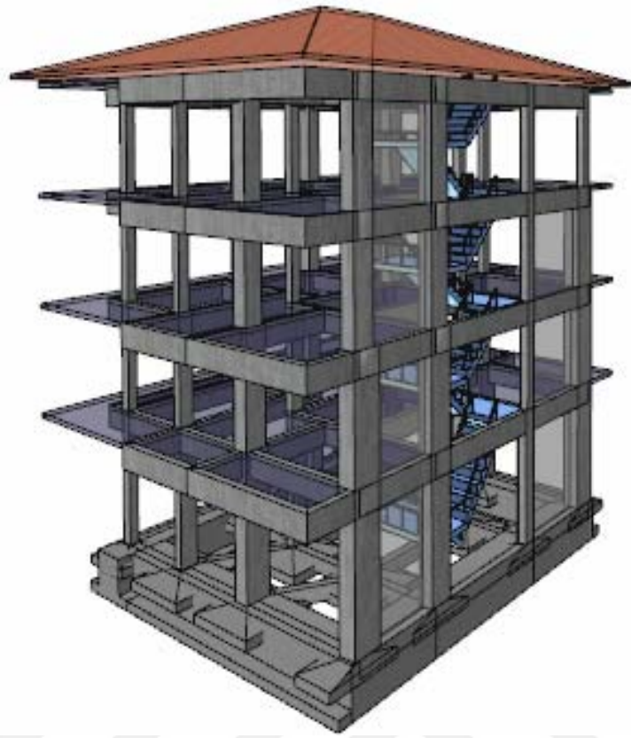
Şekil 5.48. Üçüncü güçlendirme önerisi 3 boyutlu görünüş
