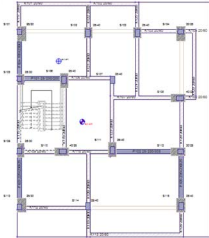
Şekil 5.20 İkinci güçlendirme önerisi 1.Normal kat kalıp planı
