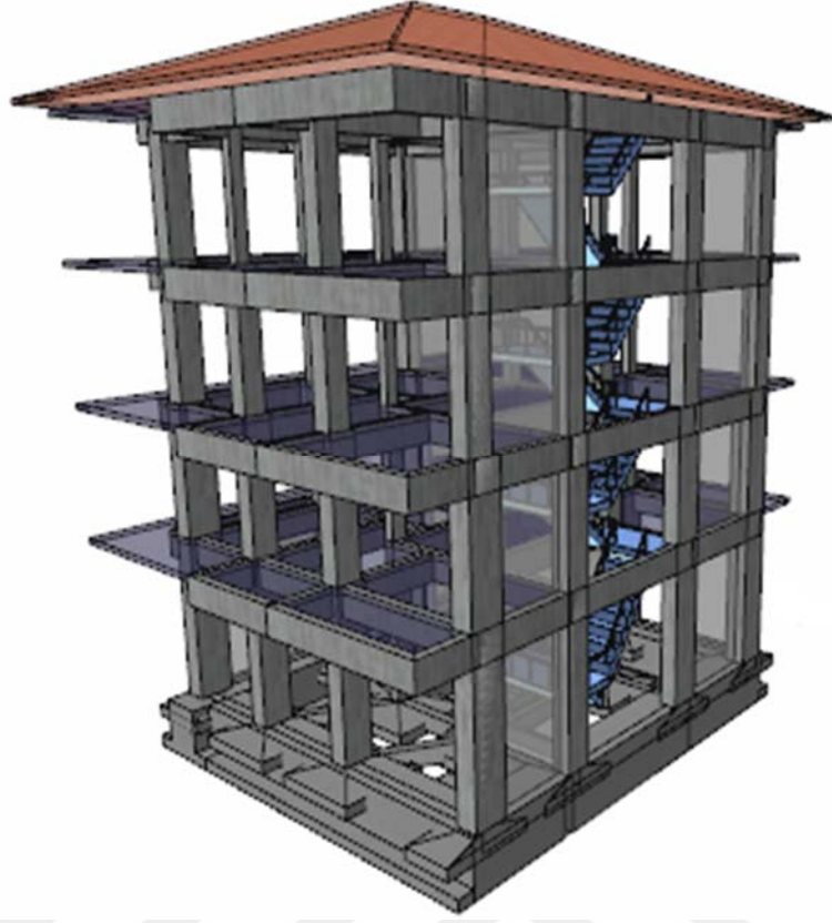
Şekil 5.43. İkinci güçlendirme önerisi 3 boyutlu görünüş
