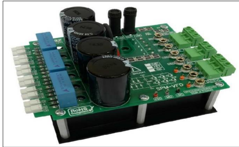
Şekil 3. 53 PAGF'de kullanılacak olan evirici güç modülü
