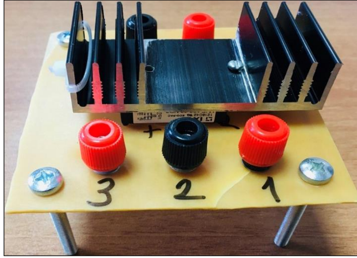
Şekil 3. 49 PAGF için hazırlanan doğrusal olmayan üç fazlı yük kaynağı
