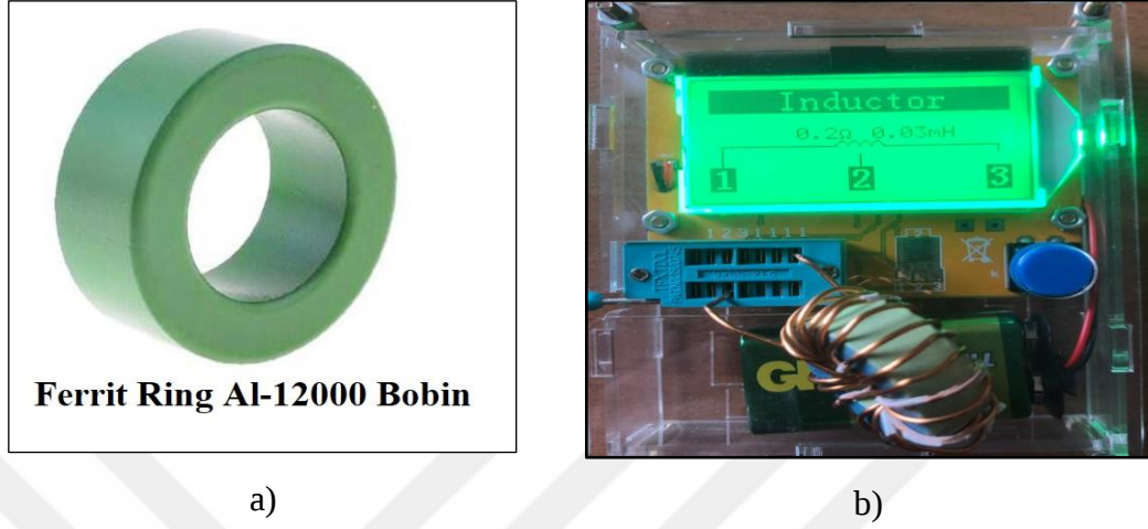
Şekil 3. 44 Filtre tasarımında kullanılan elemanlar; a) Manyetik toroid nüve, b)LCR-T4
