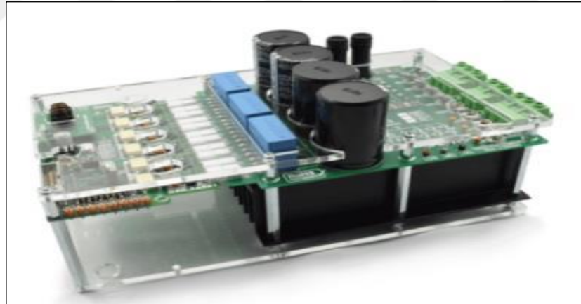
Şekil 3. 56 PAGF’de kullanılacak olan evirici güç modülü ve sürücü devresi
