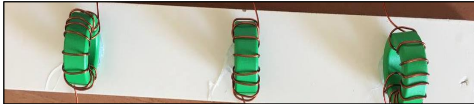
Şekil 3. 45 Evirici tarafında kullanılan üç fazlı filtre ( L_f=1,2 mH)
