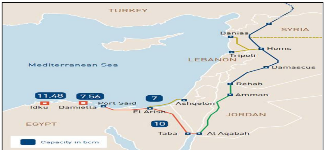
Harita 2.9: Mısır'ın LNG Tesisleri (İdku ve Damietta) ve Arap Gaz Boru Hattı Bağlantısı
