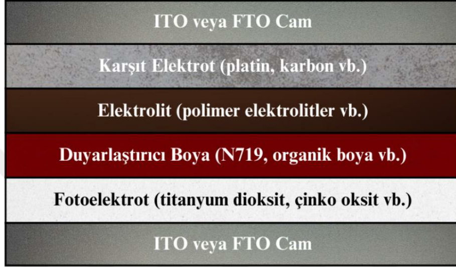
Şekil 2. Boya duyarlı güneş pillerinin bileşeni katmanlarının şematik gösterimi
