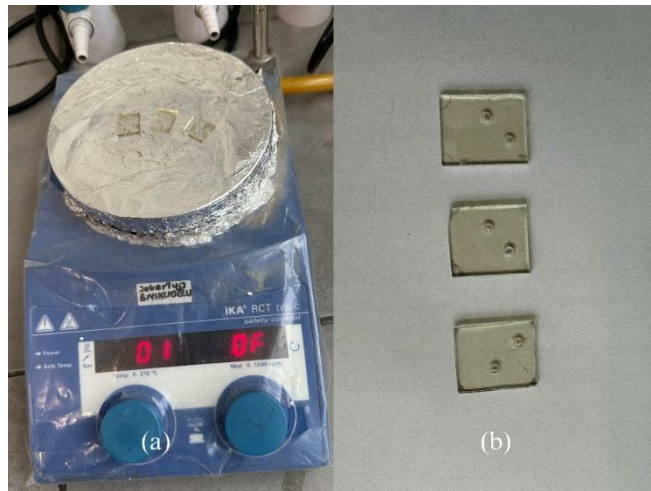
Şekil 16. (a) Delinen ve platin kaplanan camların ısıtılması (b) hazır hale getirilmesi
