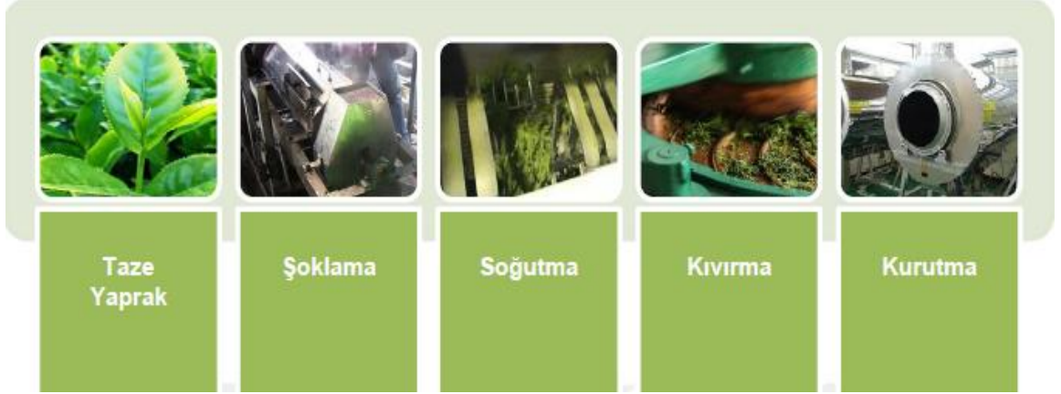
Şekil 17. Yeşil çay üretim aşamasındaki işlemler (Ofloğlu, 2019: 18).
