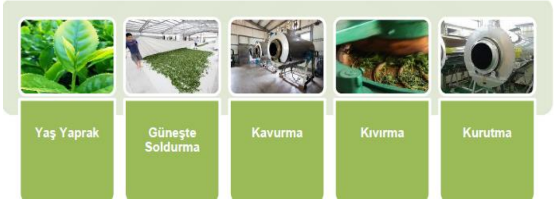
Şekil 18. Oolong çayı üretim aşamasındaki işlemler (Ofloğlu, 2019: 15).
