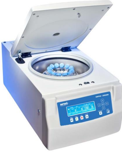
Şekil 8. Santrifüj işlemlerinde kullanılan cihaz.
