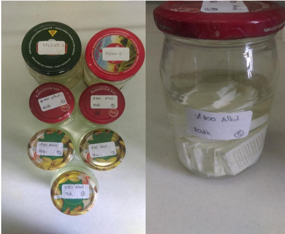
Şekil 15. Alınan örneklerin alkol ve xylene serisinden geçirme işlemi (Orijinal).
