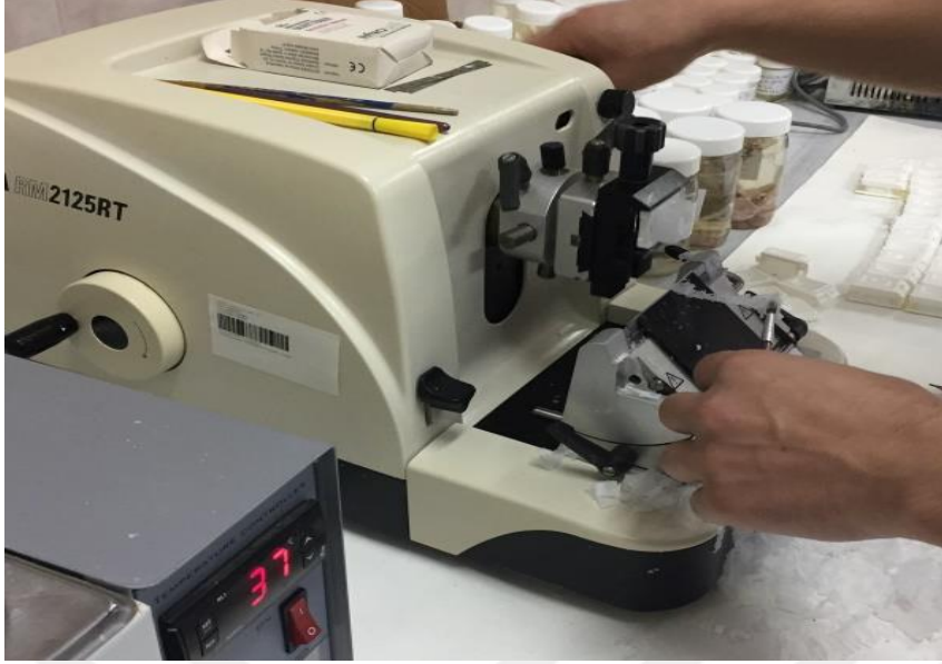
Şekil 18. Bloklanan örneklerin mikrotomda kesilmesi (Orijinal).
