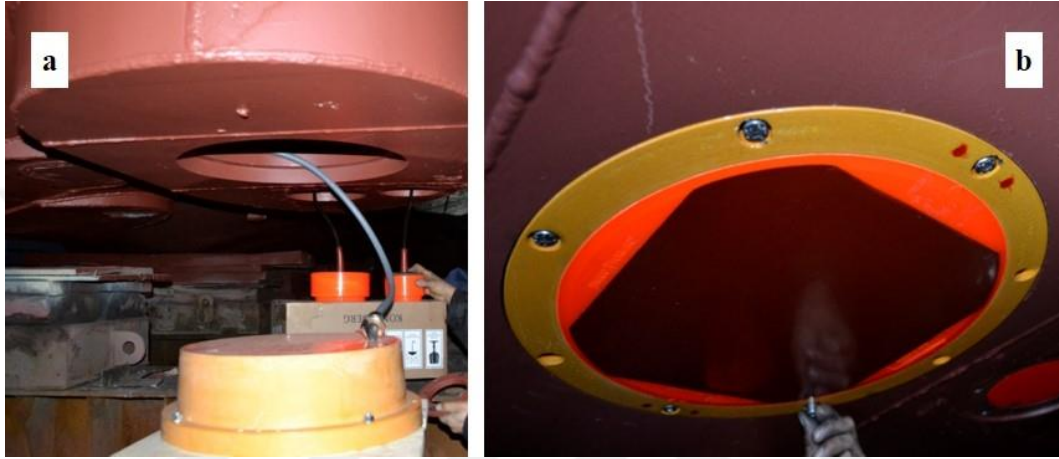
Şekil 19. 38 kHz transducer gövdesi (a) ve suya temas eden yüzeyi (b) (Bilim-2 araştırma gemisinden derlenmiştir, 2011)
