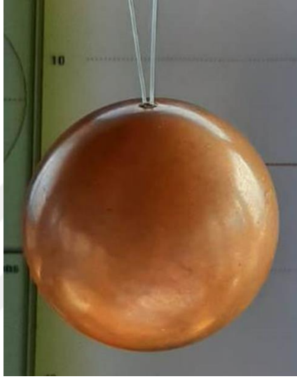
Şekil 24. Bakır kalibrasyon küresi (60 mm çapında)
