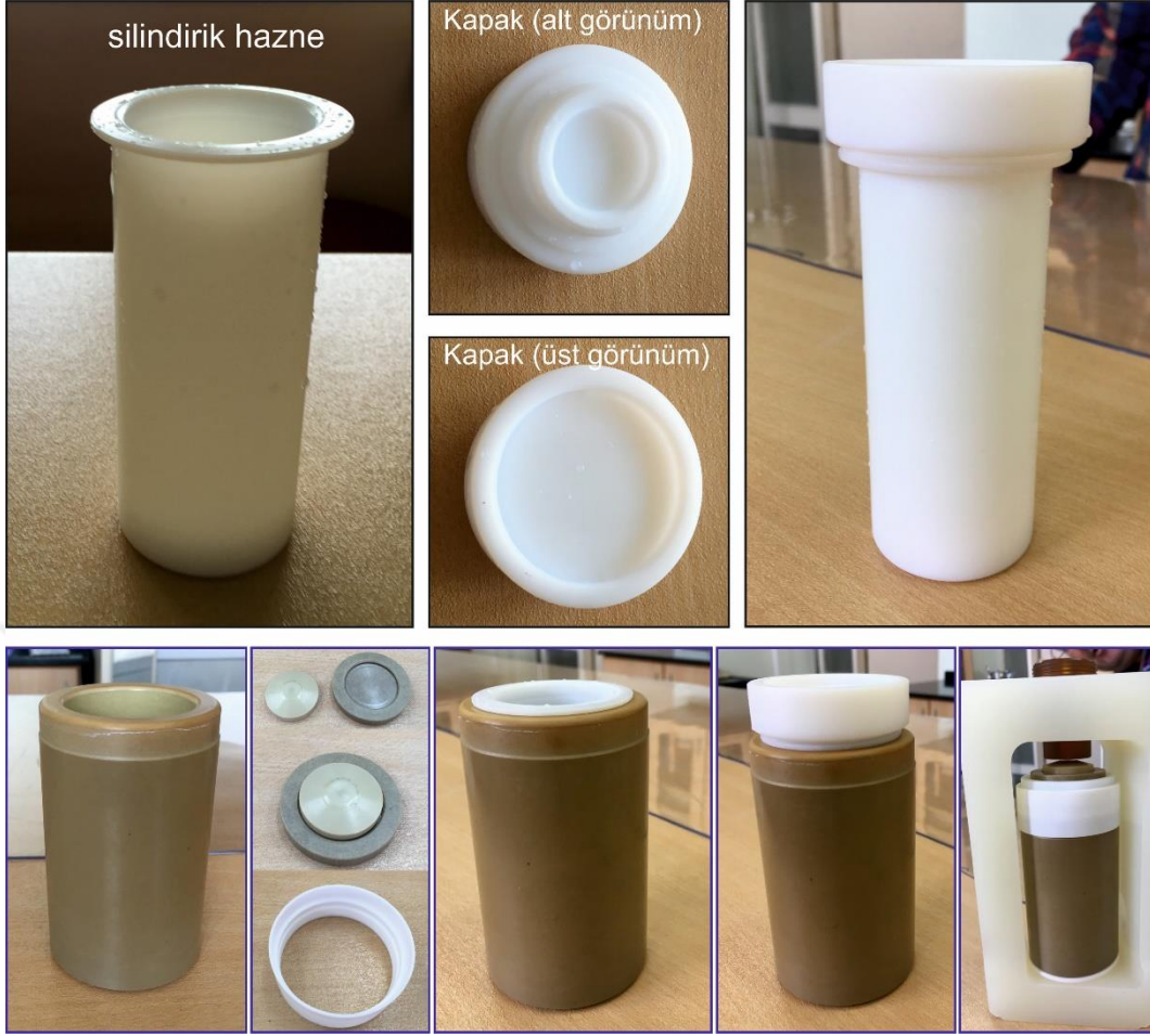
Şekil 2.4. Mineral sentezinin yapıldığı mikrodalga fırına ait 50 ml hacimli teflon hidrotermal sentez odacığı.
