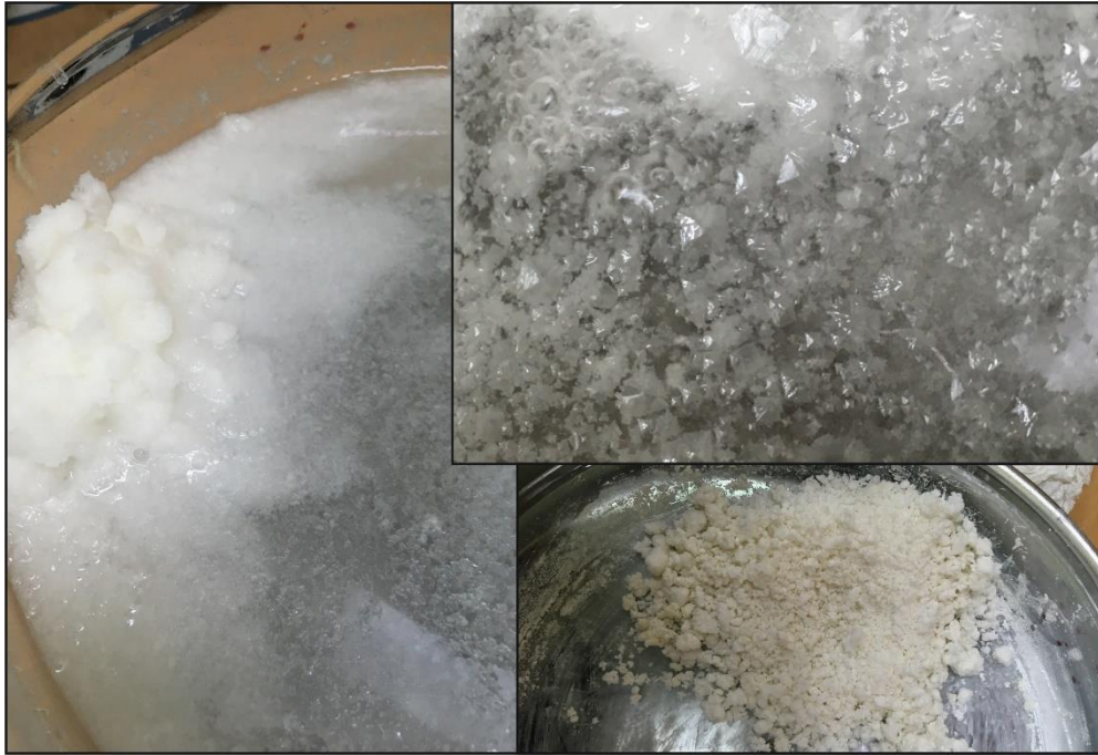
Şekil 2.3. 95 °C’de manyetik karıştırıcılı sıcak tabla üzerinde buharlaştırılan 6.5 litre deniz suyundan elde edilen 186 gr tuz.
