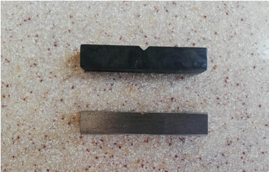
Resim 3.2 Isıı iřlem uygulanmıř ve uygulanmamıř darbe deneyi numuneleri.
