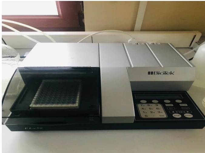
Şekil 11. ELISA BioTek ELx50 otomatik yıkama cihazı ile yıkama aşaması
