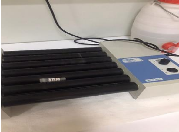
Şekil 8. Stok standardın homojen hale getirilmesi
