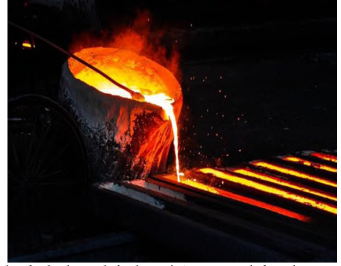
Resim 4.4. Eritilmiş metalın kalıplara dökülmesi (www.tudoksad.org.tr)
