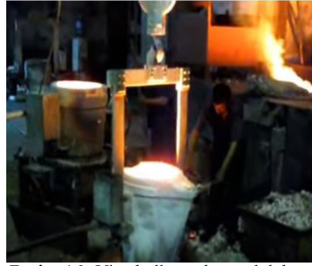
Resim 4.2. Vinç kullanarak metal dökümü
