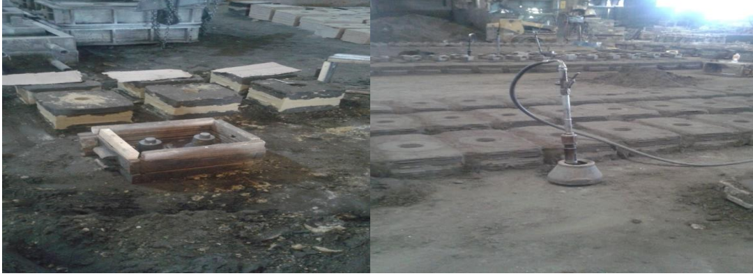
Şekil 2.4 Kalıp yapımı ve kalıp yapımında kullanılan havalı tokmak (Kişisel arşiv, 2018)
