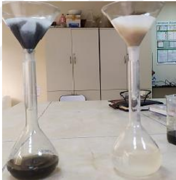
Şekil 4.4. a. Atık döküm kumu, b. Döküm kumu içeren karışımın filtre kağıdı ile süzülme işlemi.
