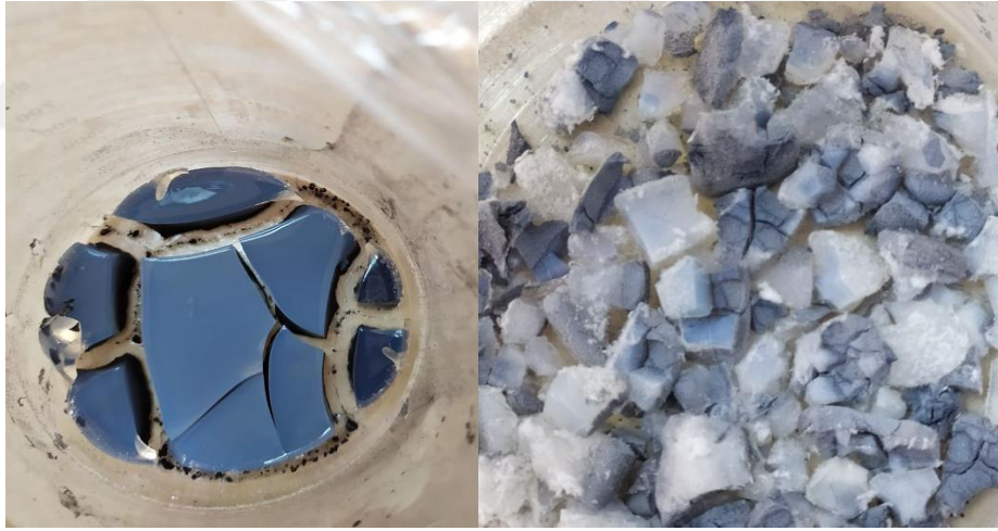
Şekil 4.10. ADK'na a. n-heptan ilavesi yapıldıktan sonraki hali, b. kurutma aşaması sonrası elde edilen silika esaslı aerjel tozları
