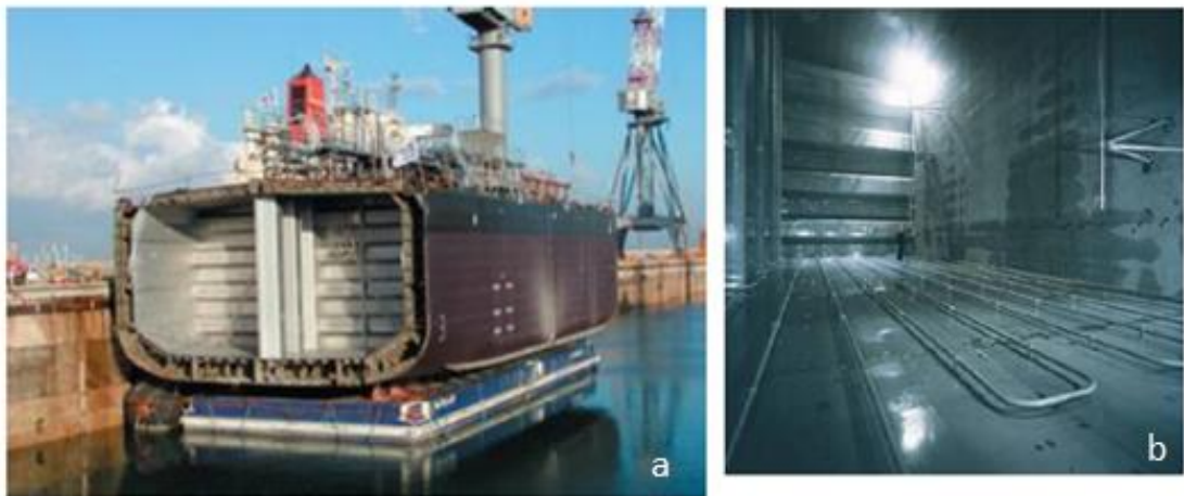
Şekil 2.2. (a) Kargo bölümü 2205 dubleks paslanmaz çelik kullanılarak imal edilmiş bir kimyasal tankerin kargo bölümü. (b) Dubleks paslanmaz çelik kullanılarak imal edilmiş bir kimyasal tankerin kargo bölümü [4].
