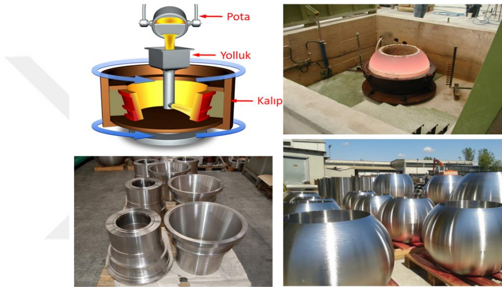
Şekil 2.13. Dikey savurma döküm görselleri verilmiştir [11] [12] [13].
