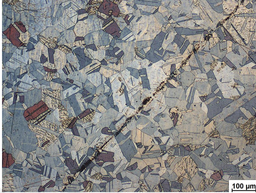
Şekil 2.38. Östenitik paslanmaz çelik mikro yapısı [69].
