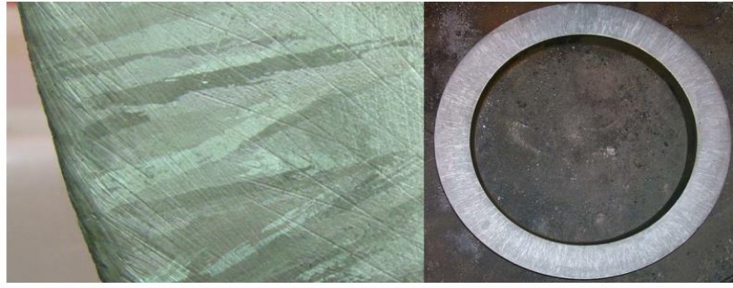
Şekil 2.12. Santrifüj dökümde yönlenmiş tane yapısı [11].
