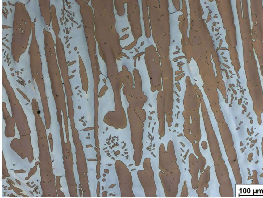
Şekil 2.41. Dubleks paslanmaz çelikmikro yapısı [69].
