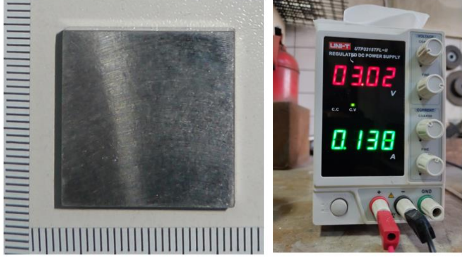
Şekil 3.20. ASTM A923-03 Method A korozyon testi görselleri.
