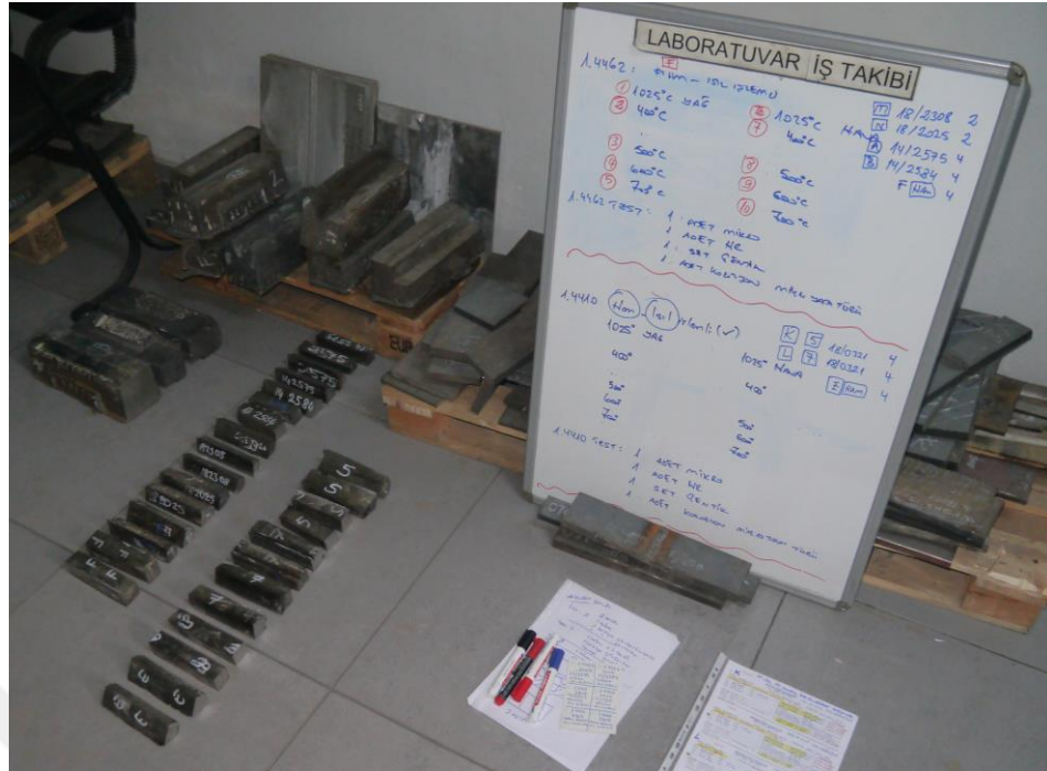
Şekil 3.2. Test bloklarından kesilen deney grupları test parçaları.
