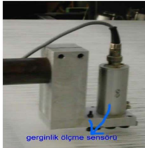
Şekil 2.6 Dokuma makinasında kullanılan gerginlik ölçme sensörü (Özkan, 2005)
