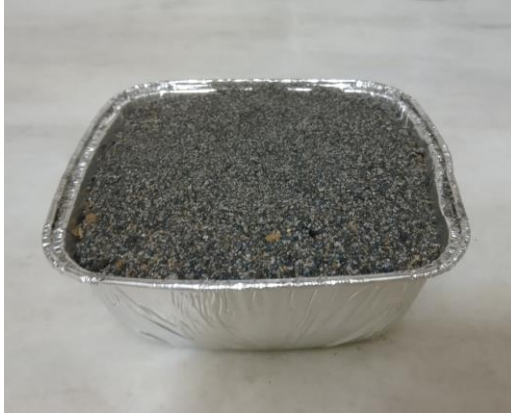
Şekil 3.2. Atık döküm kumu (CO 2 )
