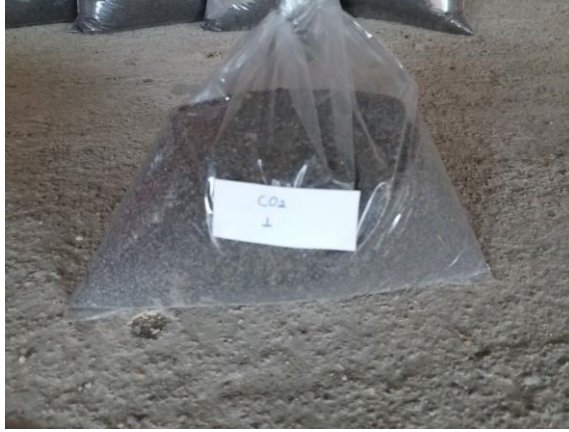
Şekil 3.4. %100 CO 2 Atık döküm kumu
