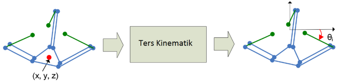
Şekil 3.7 Delta robotlara ait ters kinematik dönüşüm
