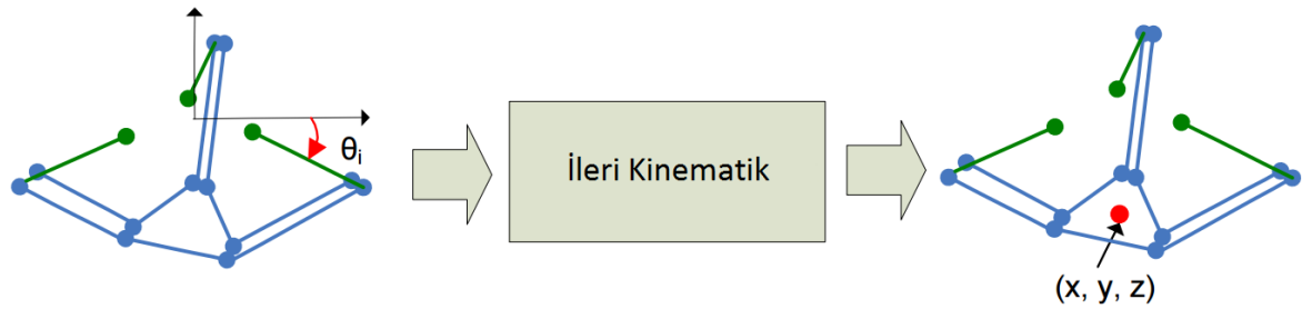
Şekil 3.6 Delta robotlara ait ileri kinematik dönüşüm
