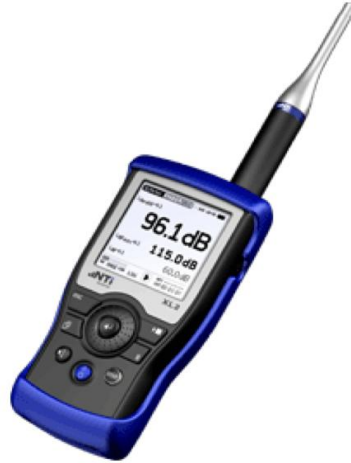
Resim 2- Çalışmamızda kullandığımız ses ölçüm cihazı (XL2 AudioandAcoustic Analyzer + M4260 Microphone,NTiAudio AG)
