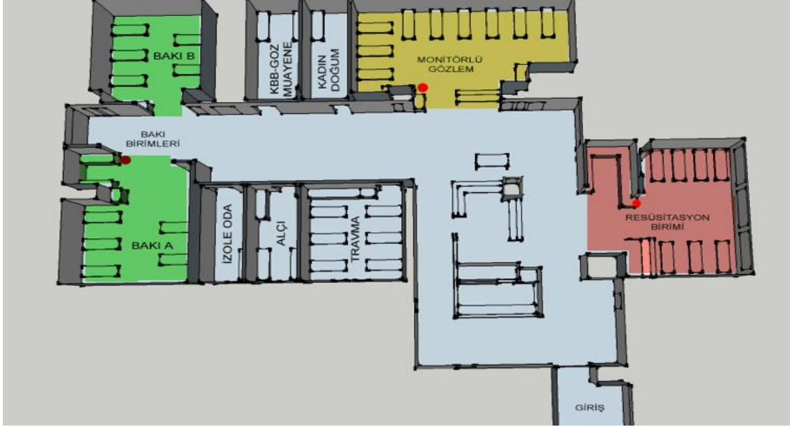
Şekil 5 – DEÜH Acil Servisinin Google-SketchUp yazılım programında üç boyutlu çizimi-CAD modeli (ölçüm yapılan alanlar kırmızı nokta ile gösterildi)
