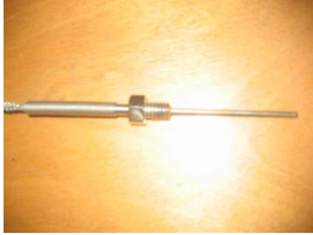
Resim 4.3. Duvar sıcaklıkları için kullanılan ısı çift [67]
