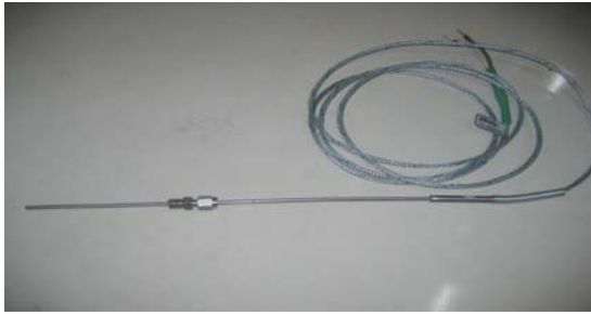
Resim 4.1. Yatak sıcaklığı ölçümünde kullanılan ısı çift [67]
