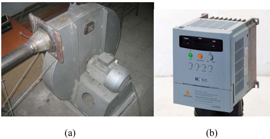
Resim 4.5. Akışkanlaşma havasını sağlayan fan (a) ve invertör (b) [67]
