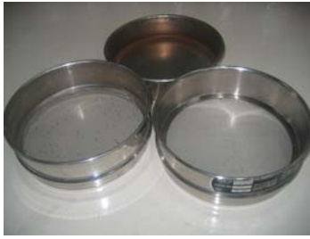
Resim 4.10. ASTM normu elek serisi [67] Resim 4.11. Mastersizer laser cihazı [67]
