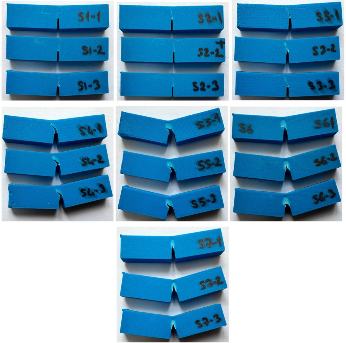
Şekil 4.13. SENB testleri sonrasında hasar görmüş numuneler
