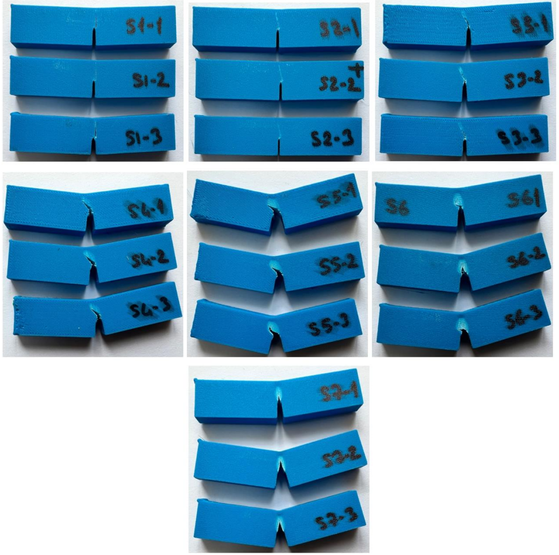
Şekil 4.13. SENB testleri sonrasında hasar görmüş numuneler
