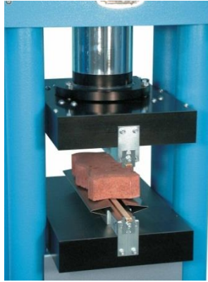
Şekil 2.33 Ayırma (yarma) deneyi düzeneği
