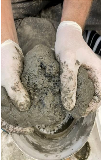
Şekil 4. 4. İşlenebilir ECC karışımı ve ECC’de mermerimsi yüzey.
