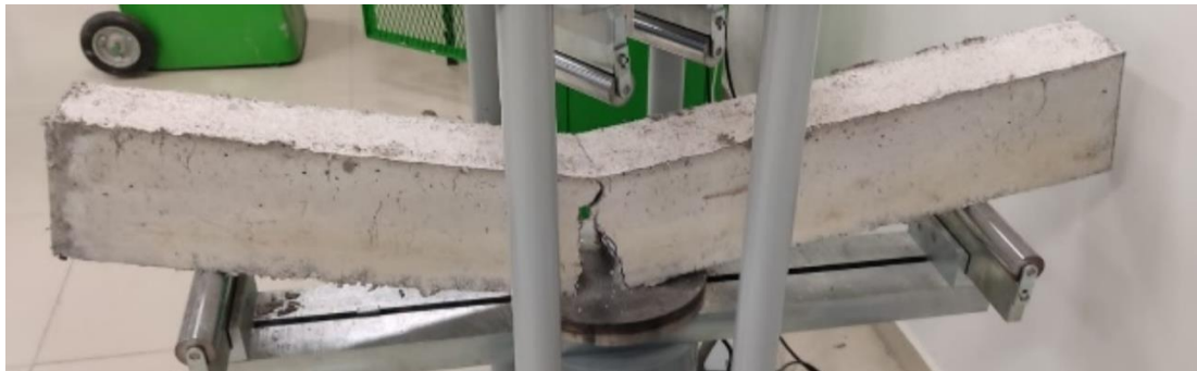
Şekil 3. 31. a-b) Şahit kiriş kiriş eğilme deneyi, c-d) ECC kiriş eğilme deneyi.
