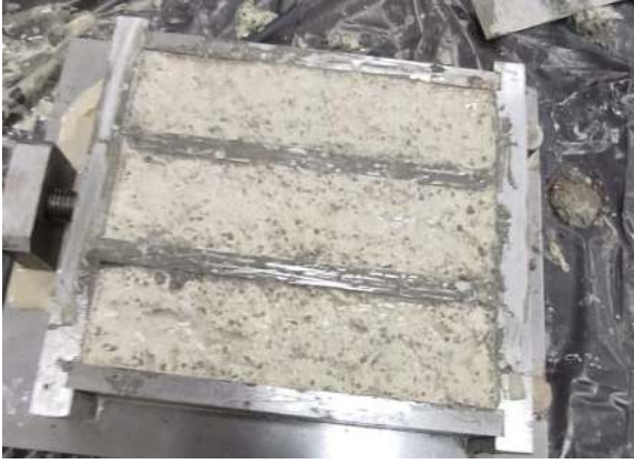
Şekil 3. 10. 40×40×160 mm boyutlarında hazırlanmış 49 adet farklı numune.
