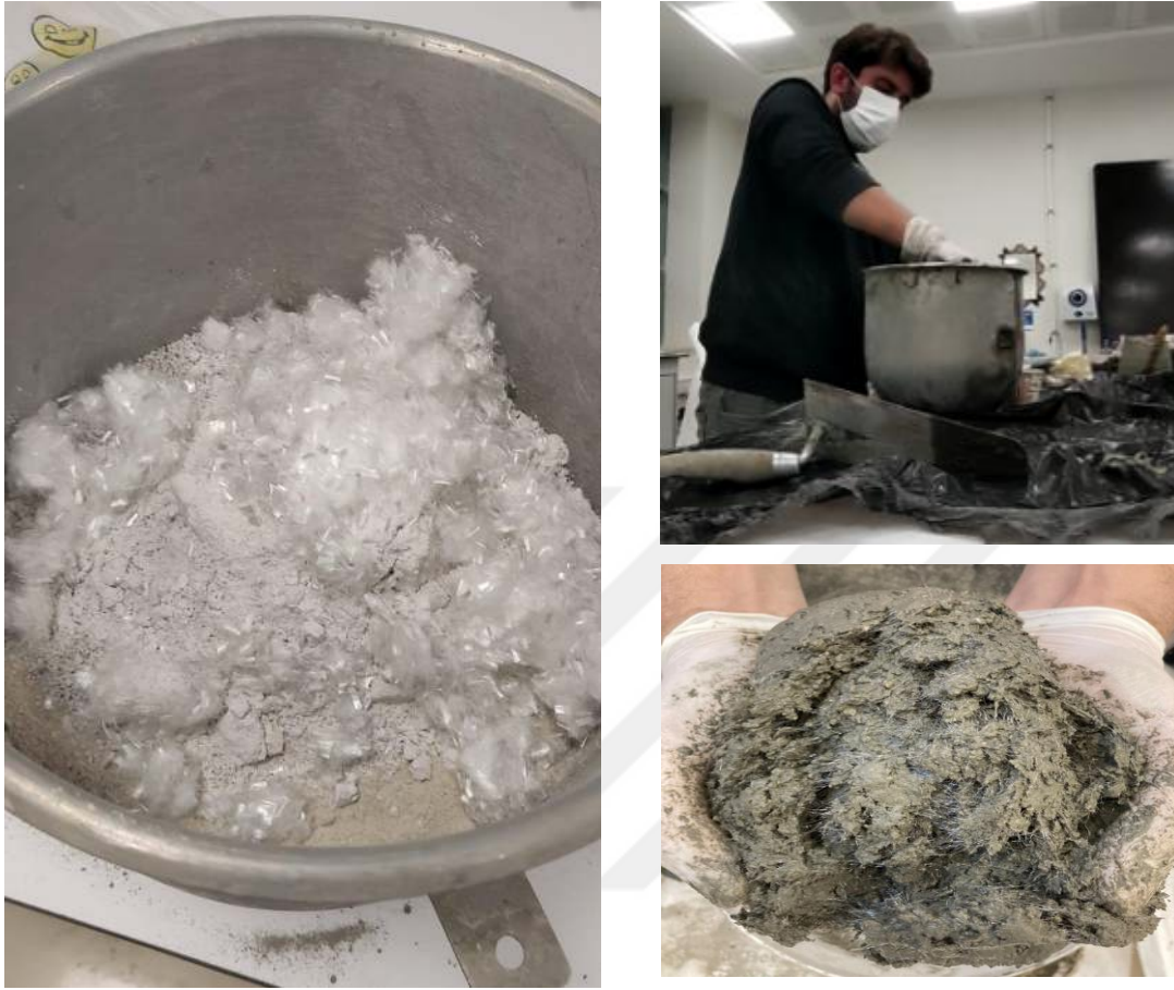
Şekil 3. 9. 40x40x160 mm numunelerin hazırlanması.
