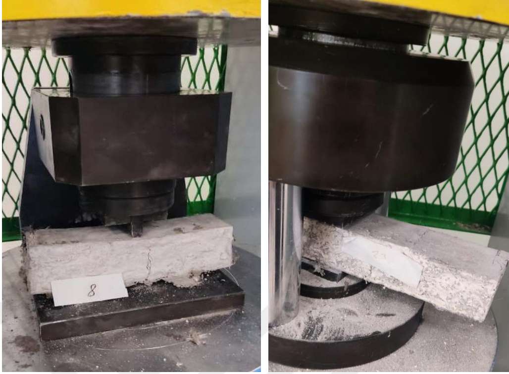
Şekil 4. 5. Deney numuneleri eğilme ve basınç testleri.
