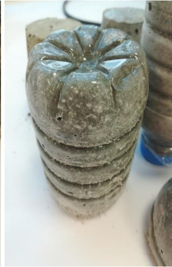
Şekil 4. 4. İşlenebilir ECC karışımı ve ECC’de mermerimsi yüzey.
