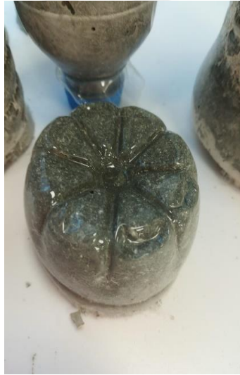
Şekil 4. 4. İşlenebilir ECC karışımı ve ECC’de mermerimsi yüzey.
