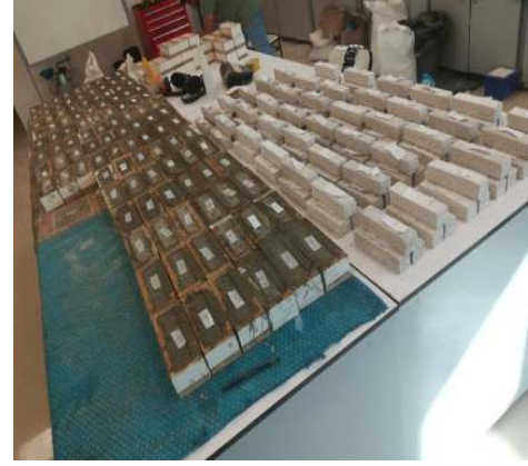
Şekil 3. 10. 40×40×160 mm boyutlarında hazırlanmış 49 adet farklı numune.
