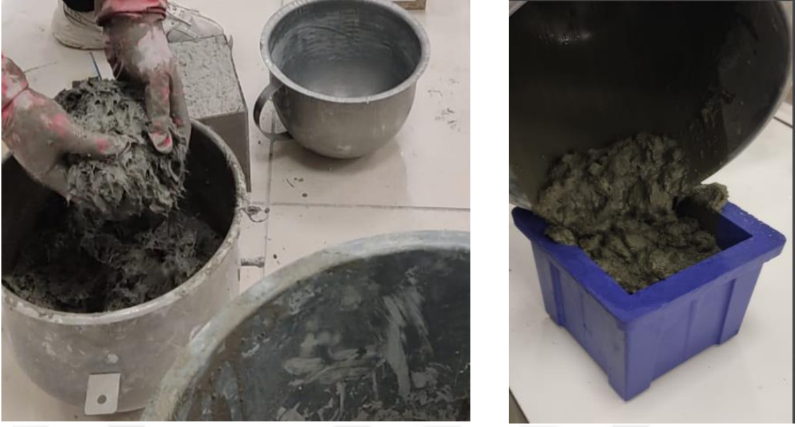
Şekil 4. 2. ECC karışımında işlenebilirlik ve kalıba yerleştirme.
