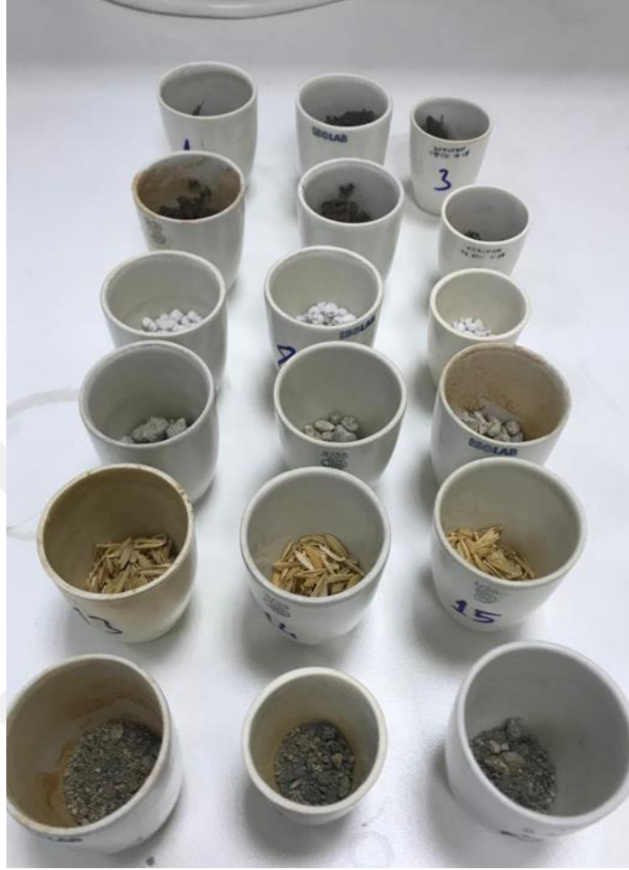
Şekil 3.9. Kül fırınında yakılacak numunelerin hazırlanması
