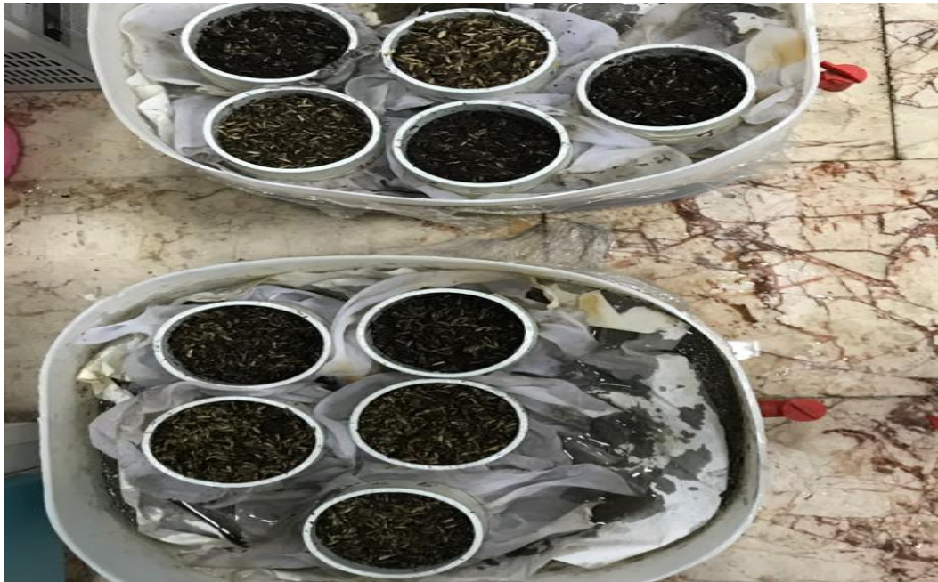
Şekil 3.5. Yetiştirme ortamı numunelerinin kum kovalarında drene edilmesi
