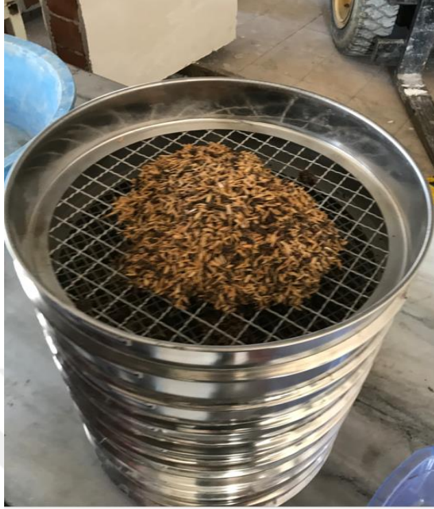
Şekil 3.2. Yetiştirme ortamı numunelerinin titreşimli elek setinden elenmesi
