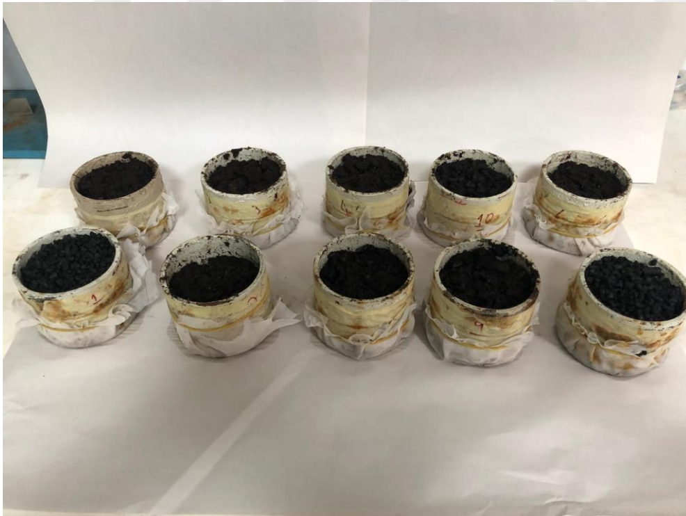
Şekil 3.4. Yetiştirme ortamlarının toplam porozitesinin belirlenmesi
