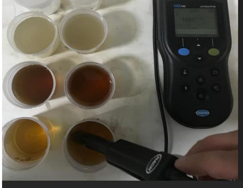
řekil 3.8. Yetiřtirme ortamlarında pH ve elektriksel iletkenlik ölçümü
