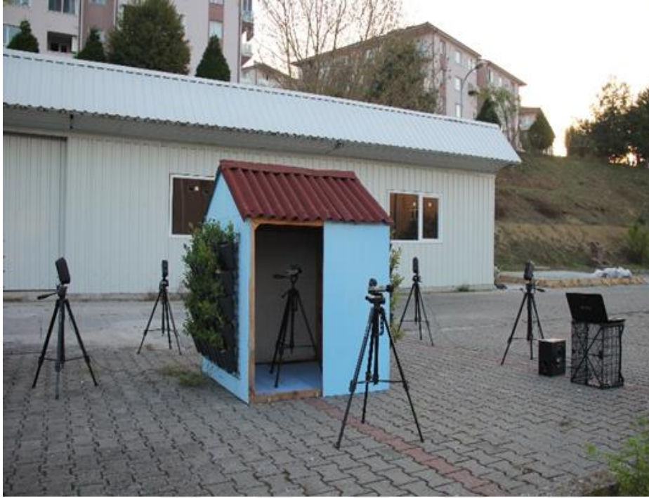
Şekil 3.18. Yeşil duvar sistemlerinde gürültü ölçümü
