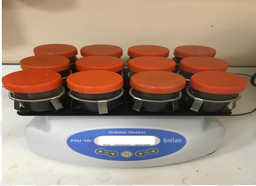
řekil 3.7. 1:5 oranında numune ve saf su karışımlarının hazırlanması
