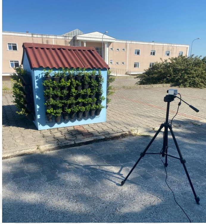
Şekil 3.17. Yeşil duvar sistemlerinin termal kamera ile görüntülenmesi
