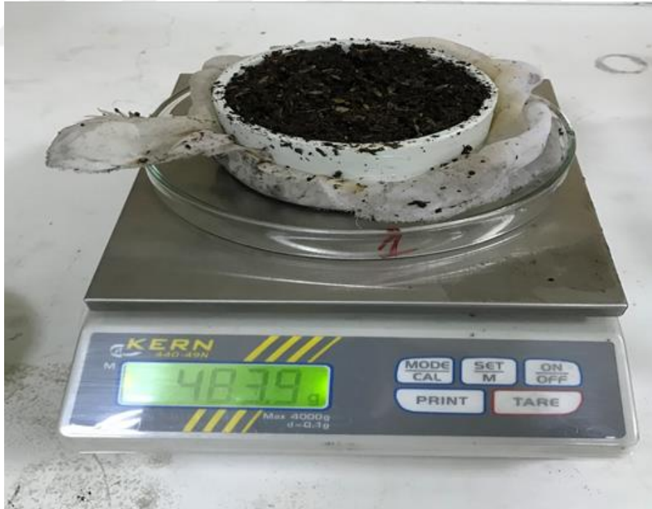
Şekil 3.3. Yetiştirme ortamlarının hacim ağırlığının belirlenmesi
