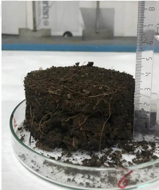
Şekil 3.6. Çelik halkalardan çıkartılan kuru numunelerin hacminin belirlenmesi
