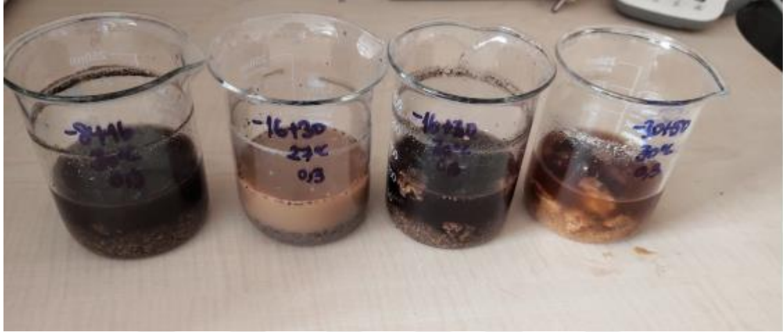
Şekil 3.3. Kolondan alan numunenin su eklenerek ekstraksiyona hazır hale getirilmesi
