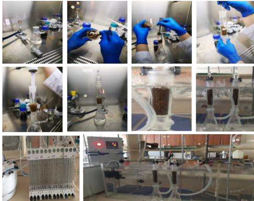
Şekil 3.2. Kolonların doldurulması ve reaktör sistemi
