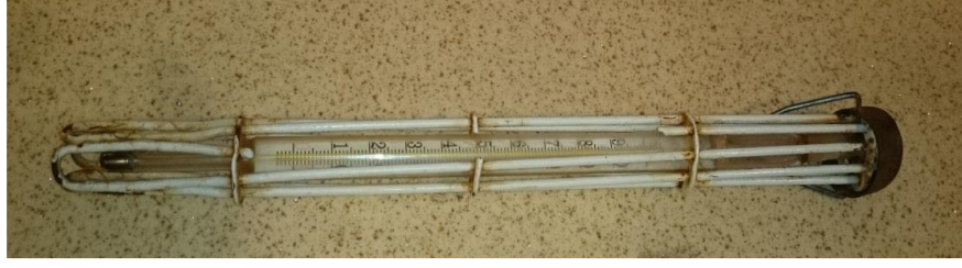
Şekil 6. Düzenli sistem suyu sıcaklığının ölçülmesinde kullanılan muhafazaya alınmış cıvalı termometre.
