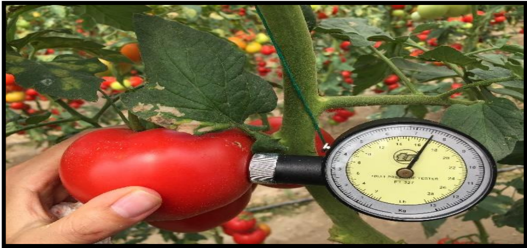
Şekil 4.3. a,b ) Penetrometre ile denemeye giren domates çeşitlerinin meyve sertlik ölçümü
